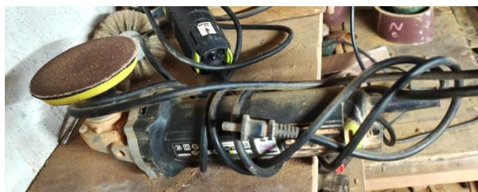
图 42 手提式磨光机
