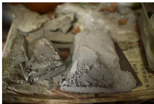
图 7-2-20 草筋灰（卢芝高嵌瓷工作室）
