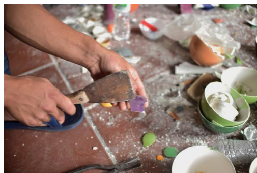
图 7-2-13 灰铲打胚（卢芝高嵌瓷工作室）
