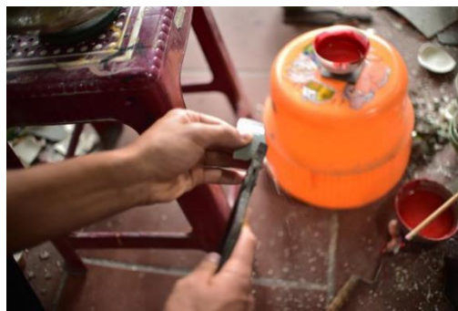
图 7-2-15 修剪瓷片（卢芝高嵌瓷工作室）
