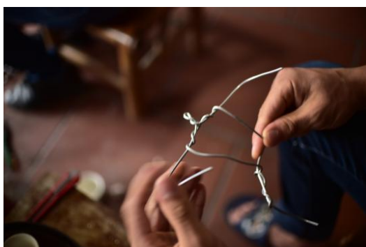
图 7-2-19 缚瓦骨（卢芝高嵌瓷工作室）
