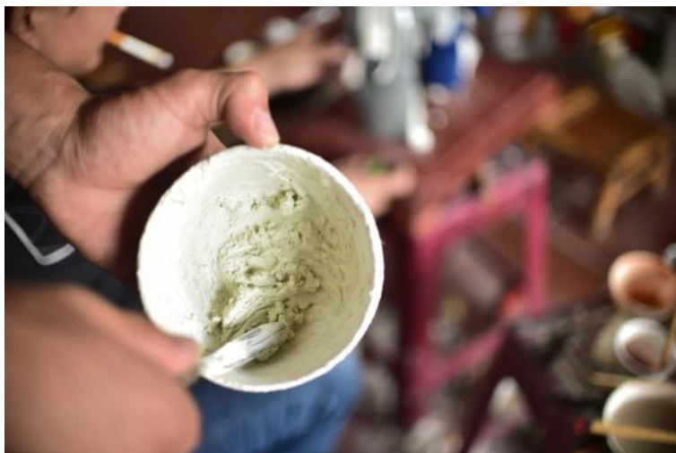
图 7-2-18 调制贝壳灰泥（卢芝高嵌瓷工作室）
