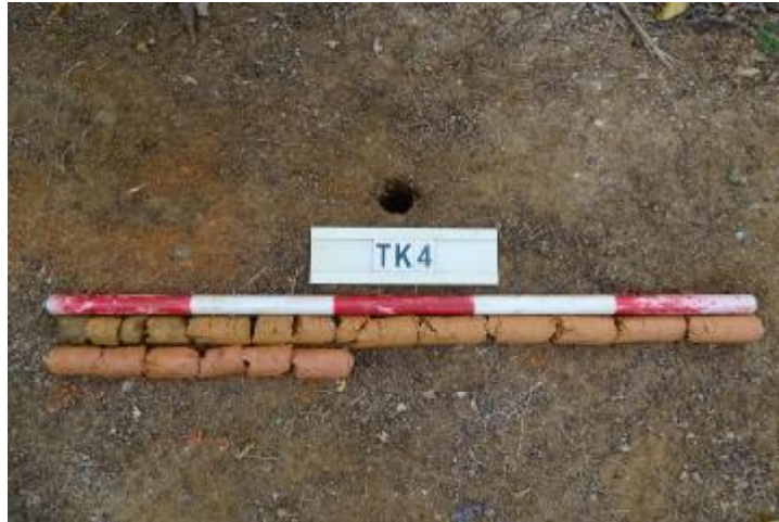
图 73 TK4 土样（一米标杆，土样由左上往右下）
