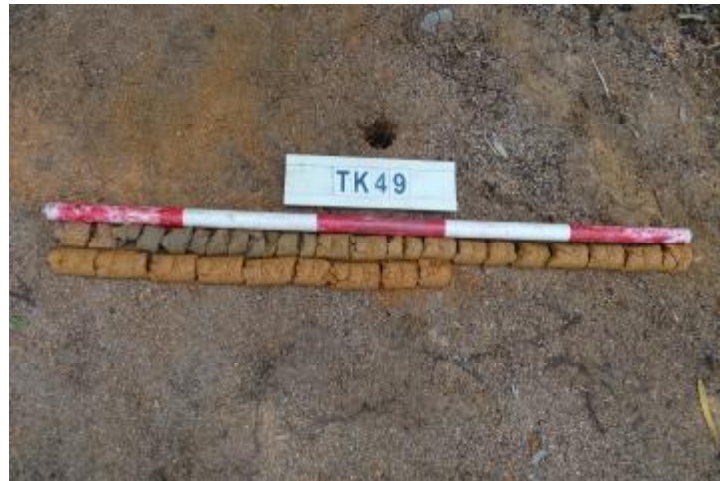
图 99 TK49 土样（一米标杆，土样由左上往右下）
