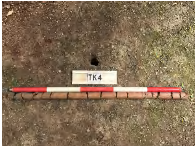
图 47 TK4 土样（标杆长 1 米，土样由左到右）
