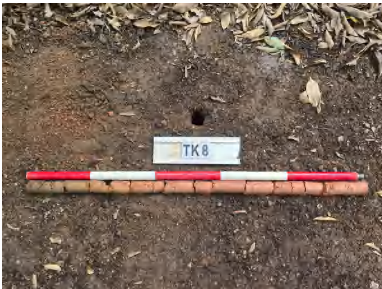
图 51 TK8 土样（标杆长 1 米，土样由左到右）
