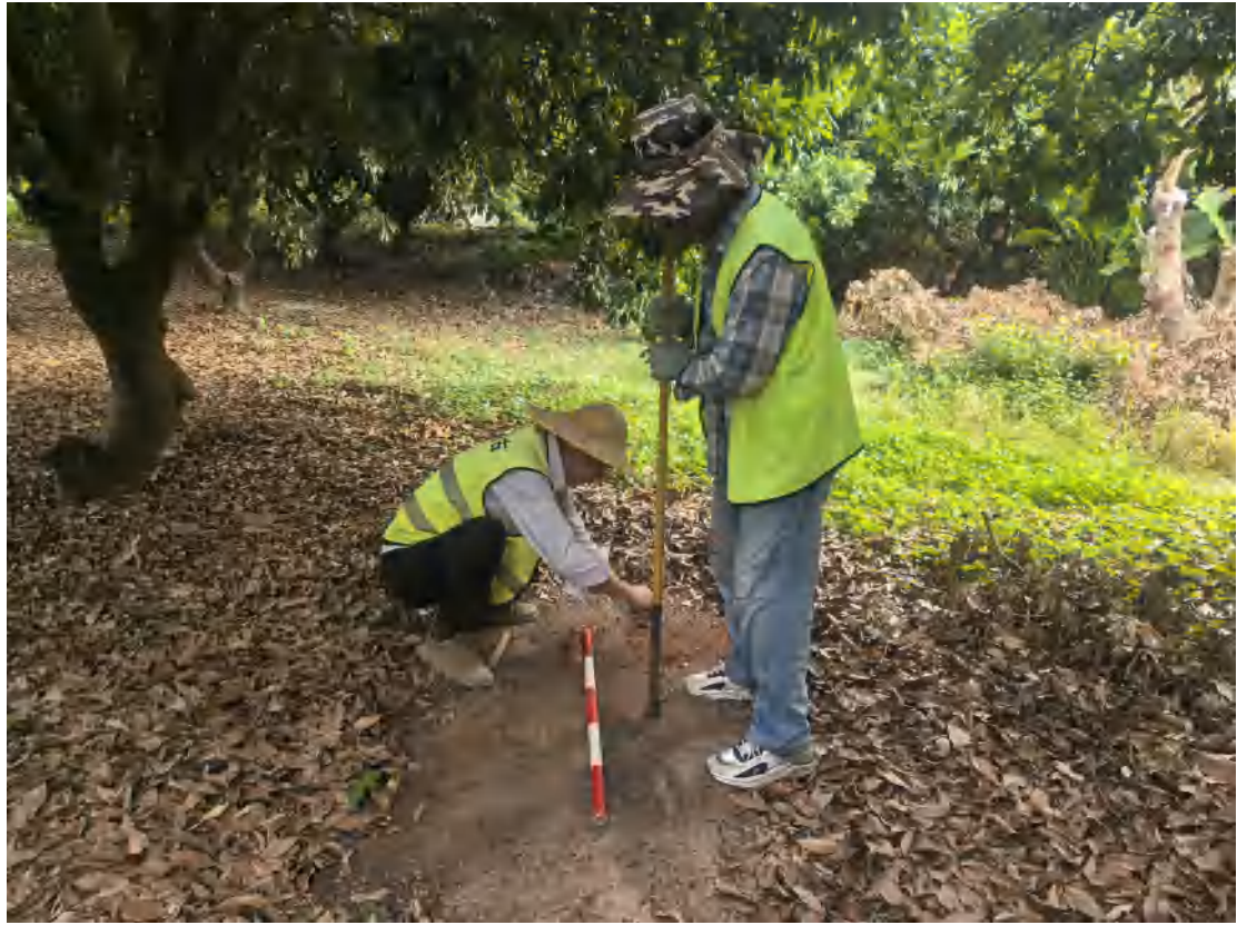
图 42 提取标准探孔土样（西-东）
