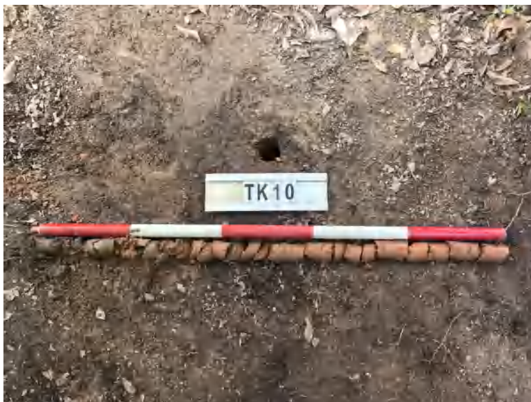
图 53 TK10 土样（标杆长 1 米，土样由左到右）
