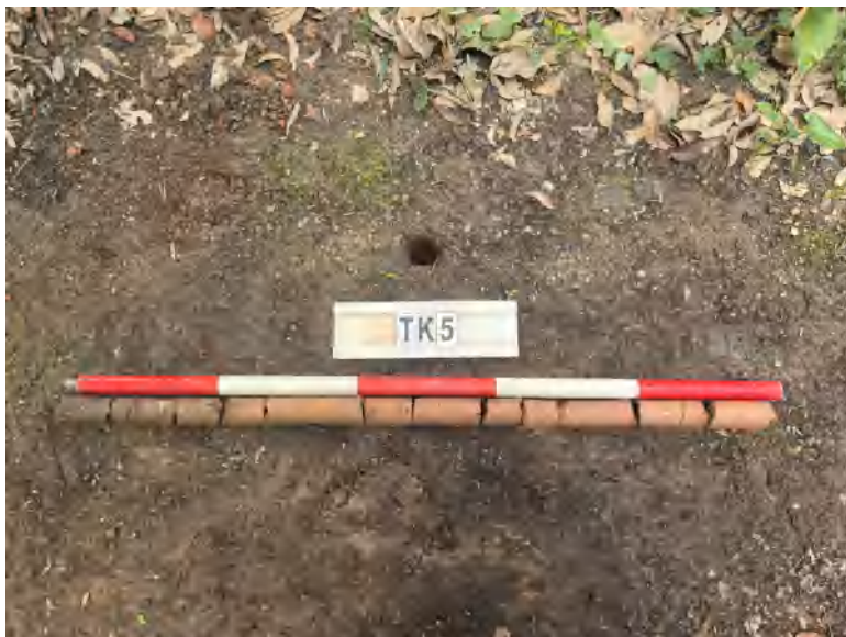
图 48 TK5 土样 (标杆长 1 米, 土样由左到右)
