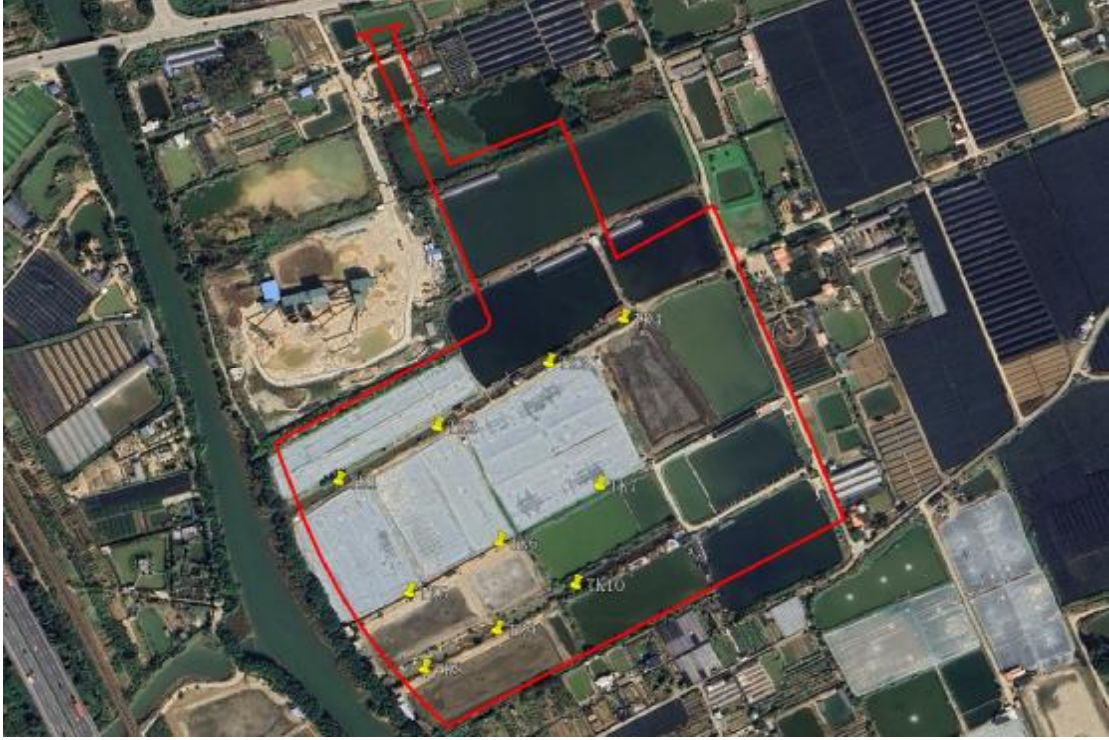
图 25 标准型探孔位置分布图（黄色标记点）
