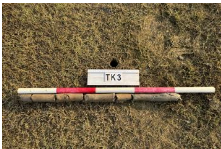
图 37 TK3 土样 (一米标杆, 土样由左往右)
