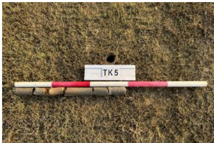
图 47 TK5 土样（一米标杆，土样由左往右）
