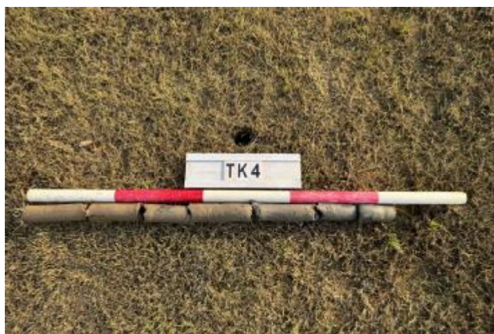
图 38 TK4 土样 (一米标杆, 土样由左往右)
