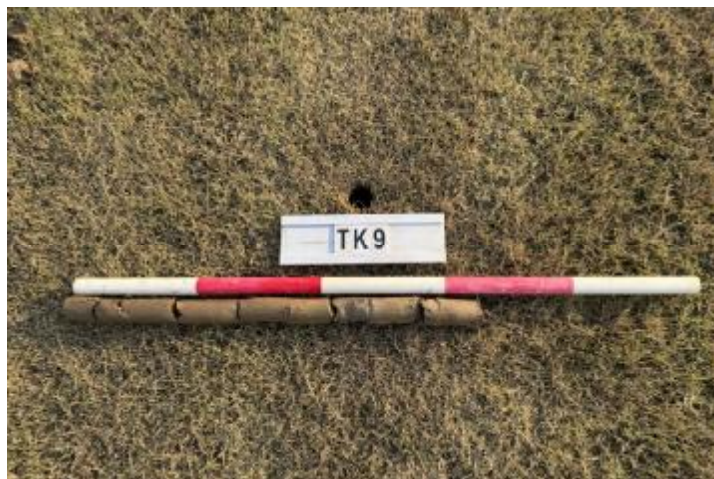
图 51 TK9 土样（一米标杆，土样由左往右）
