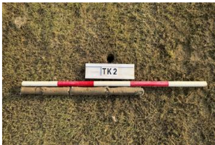
图 36 TK2 土样 (一米标杆, 土样由左往右)
