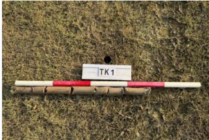
图 35 TK1 土样 (一米标杆, 土样由左往右)
