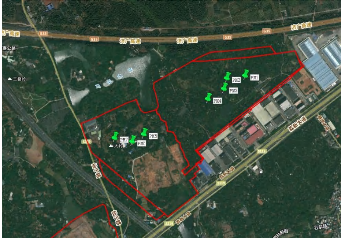
图 149 项目勘探区域剖面分布示意图（绿色标记点）
