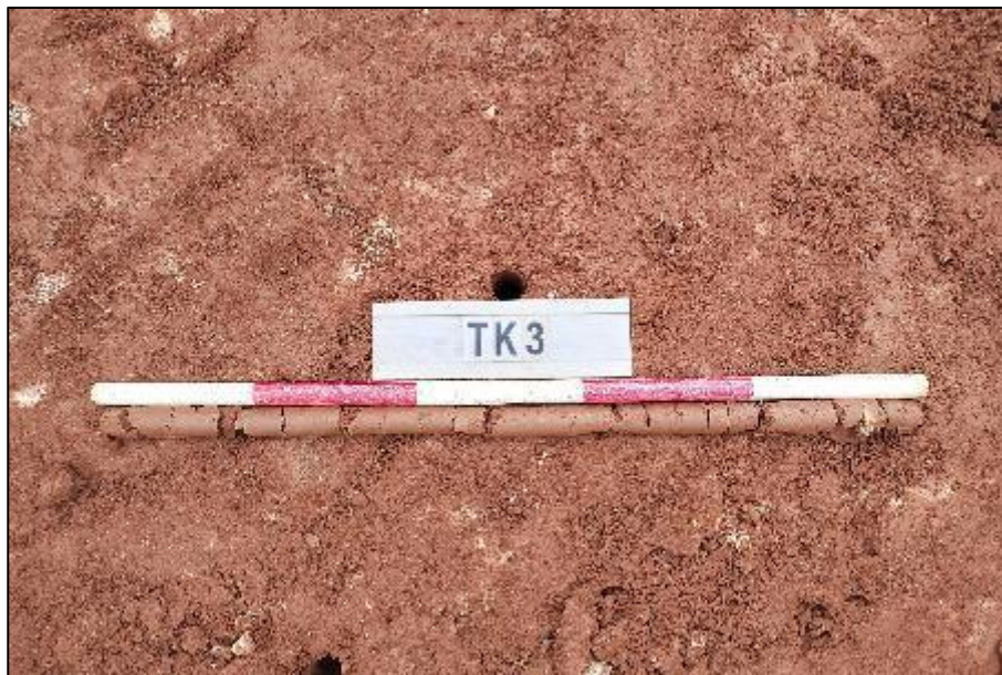
图 102 TK3 土样（标杆长 1 米，土样由左到右）
