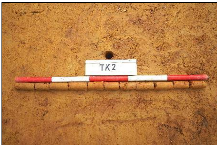
图 80 TK2 土样 (标杆长 1 米, 土样由左到右)
