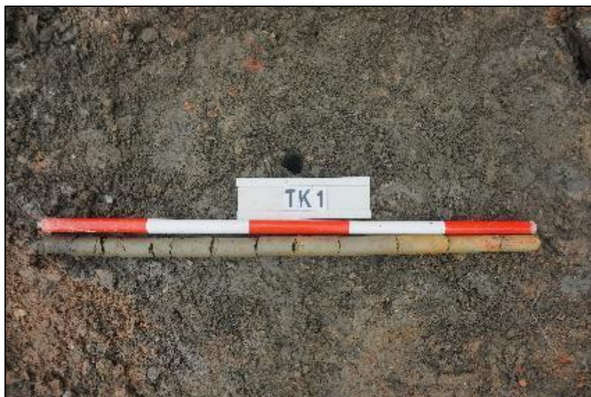
图 55 TK1 土样 (标杆长 1 米, 土样由左到右)
