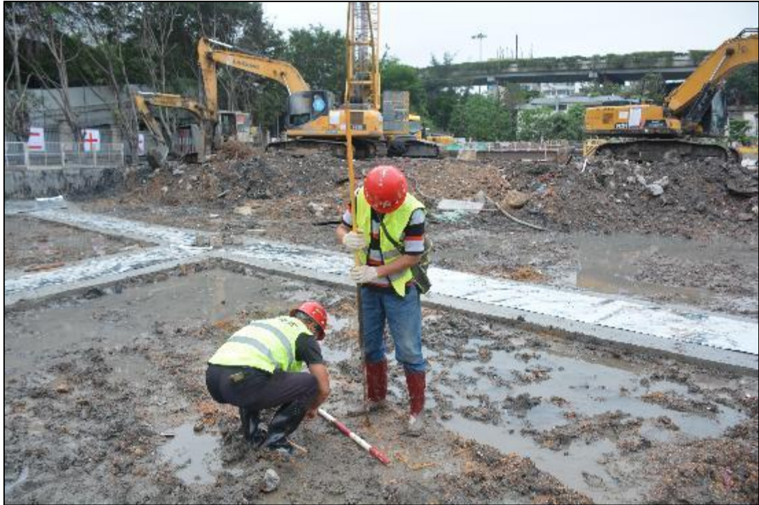
图 51 提取标准孔土样工作照（西-东）
