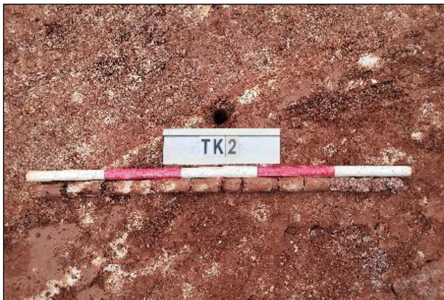
图 101 TK2 土样 (标杆长 1 米, 土样由左到右)
