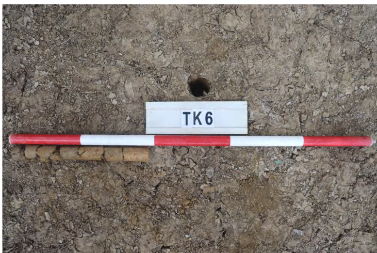
图 40 TK6 土样（一米标杆，土样由左往右）
