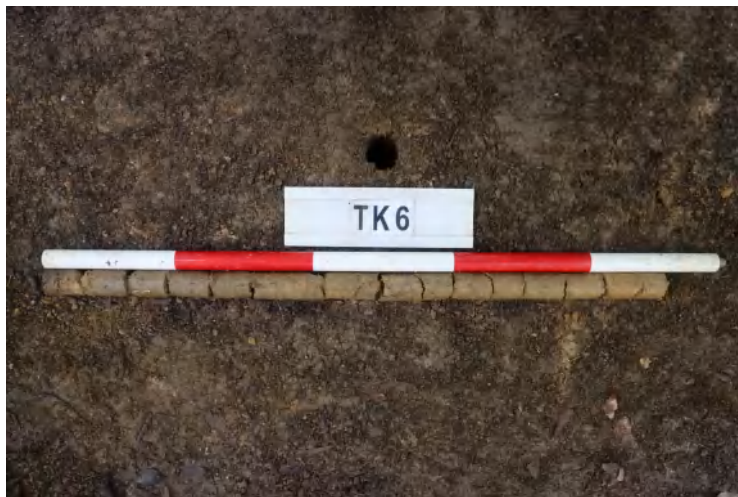
图 44 TK6 土样 (一米标杆,土样由左往右)
