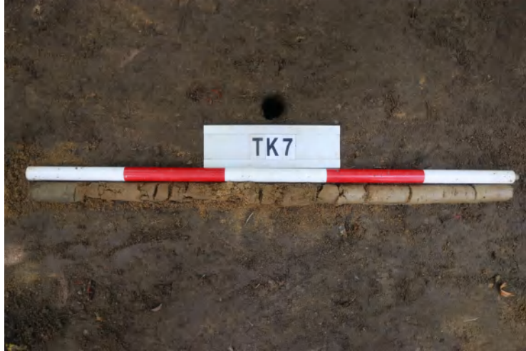
图 45 TK7 土样 (一米标杆,土样由左往右)
