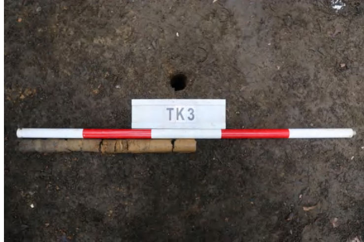
图 41 TK3 土样 (一米标杆,土样由左往右)
