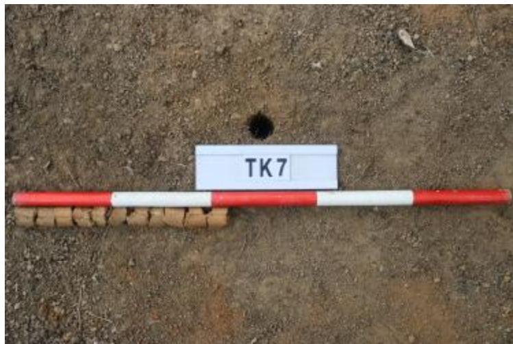
图 41 TK7 土样 (一米标杆,土样由左往右)
