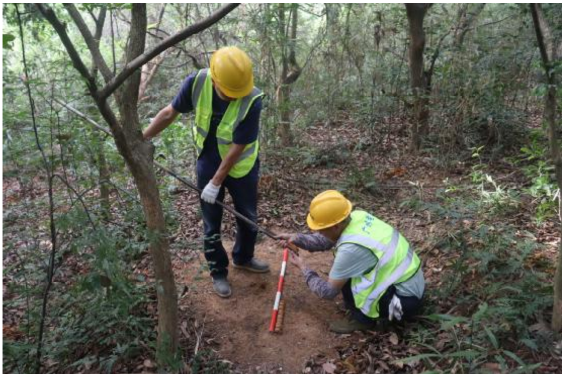
图 34 标准探孔土样分析工作照（北-南）
