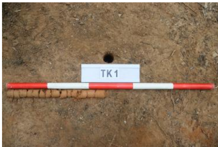
图 35 TK1 土样 (一米标杆,土样由左往右)
