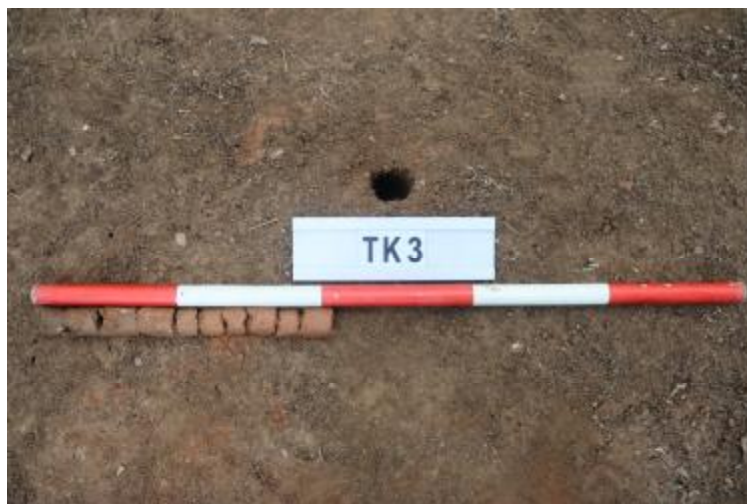
图 37 TK3 土样 (一米标杆, 土样由左往右)
