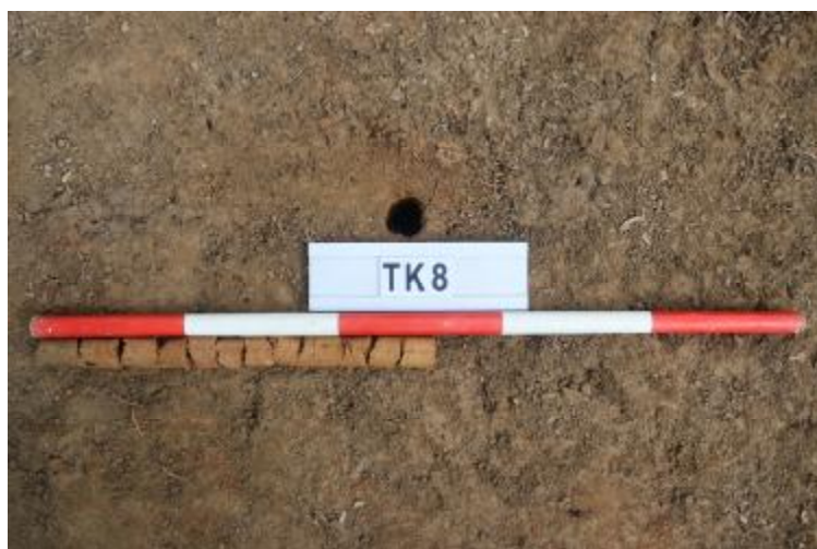
图 42 TK8 土样 (一米标杆,土样由左往右)
