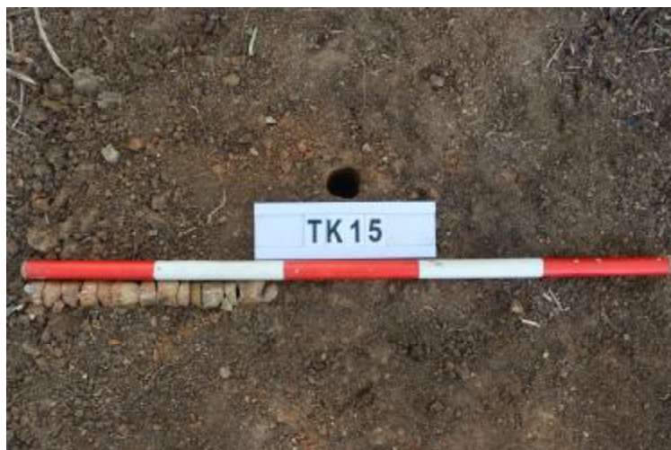
图 49 TK15 土样 (一米标杆, 土样由左往右)
