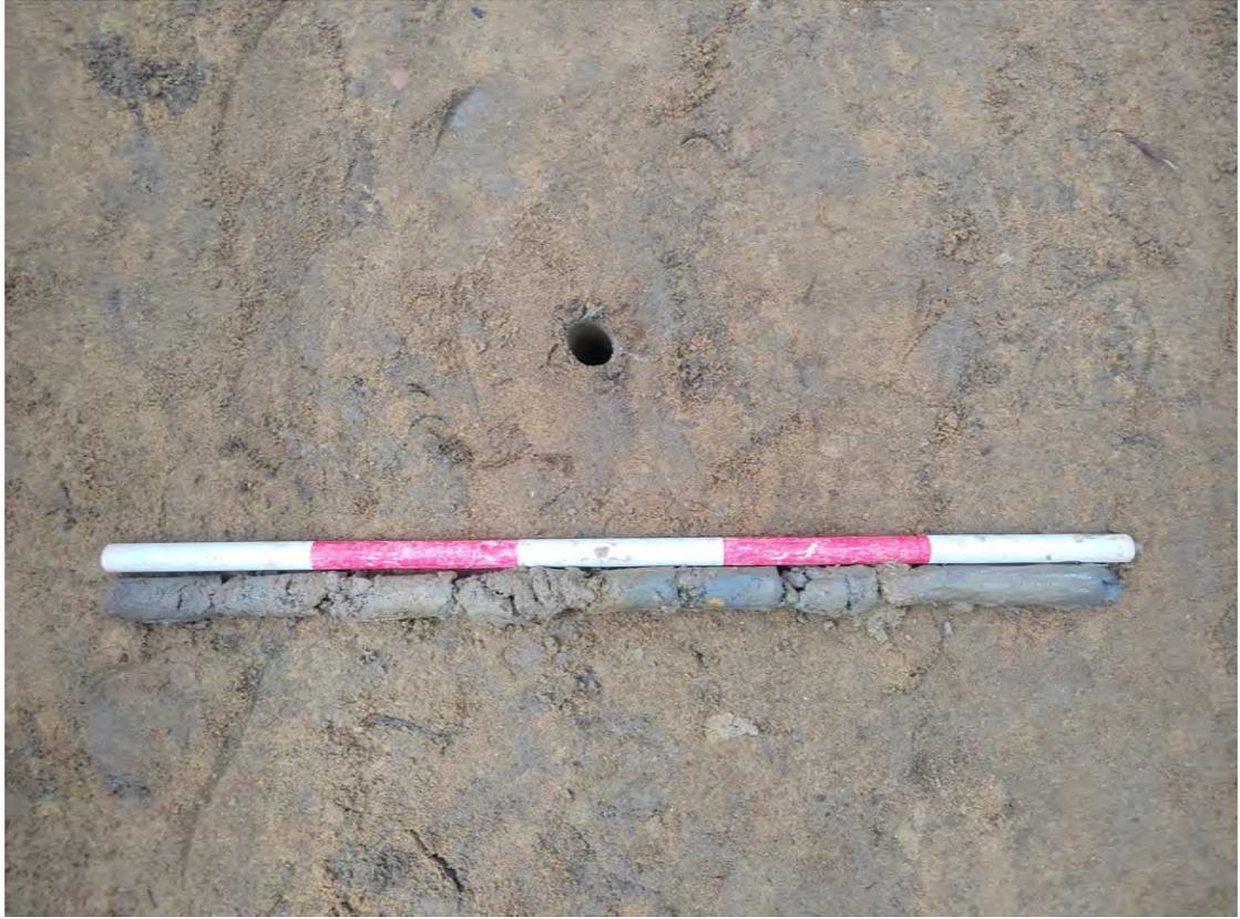
图 62 TG1 底部探孔土样（1 米标尺，土样由左往右）
