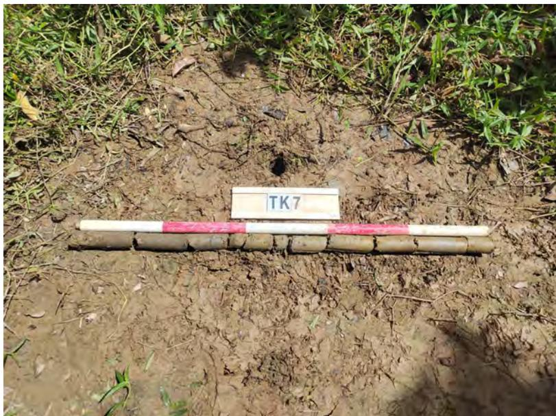
图 45 TK7 土样 (标杆长 1 米, 土样由左到右)
