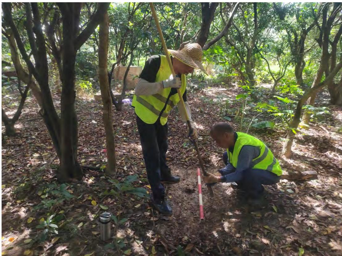
图 37 提取标准孔土样（西-东）
