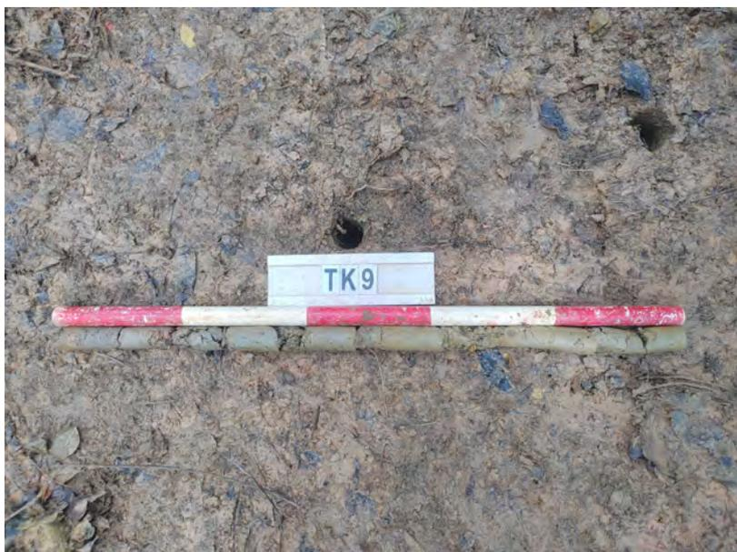
图 47 TK9 土样（标杆长 1 米，土样由左到右）
