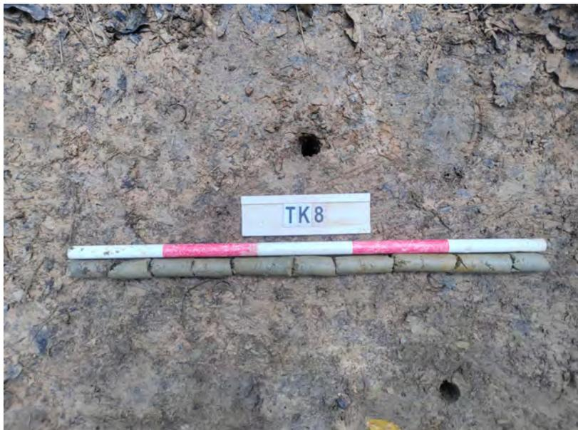
图 46 TK8 土样 (标杆长 1 米, 土样由左到右)
