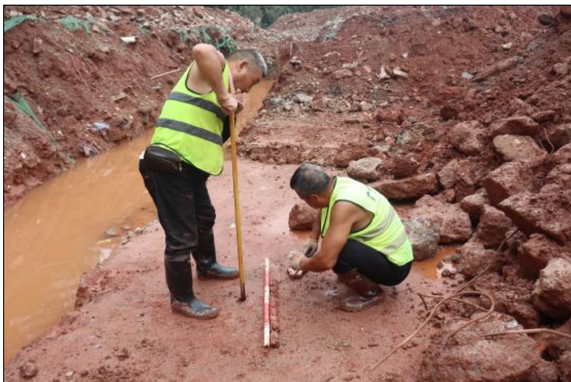
图 28 提取标准探孔土样工作照（南-北）
