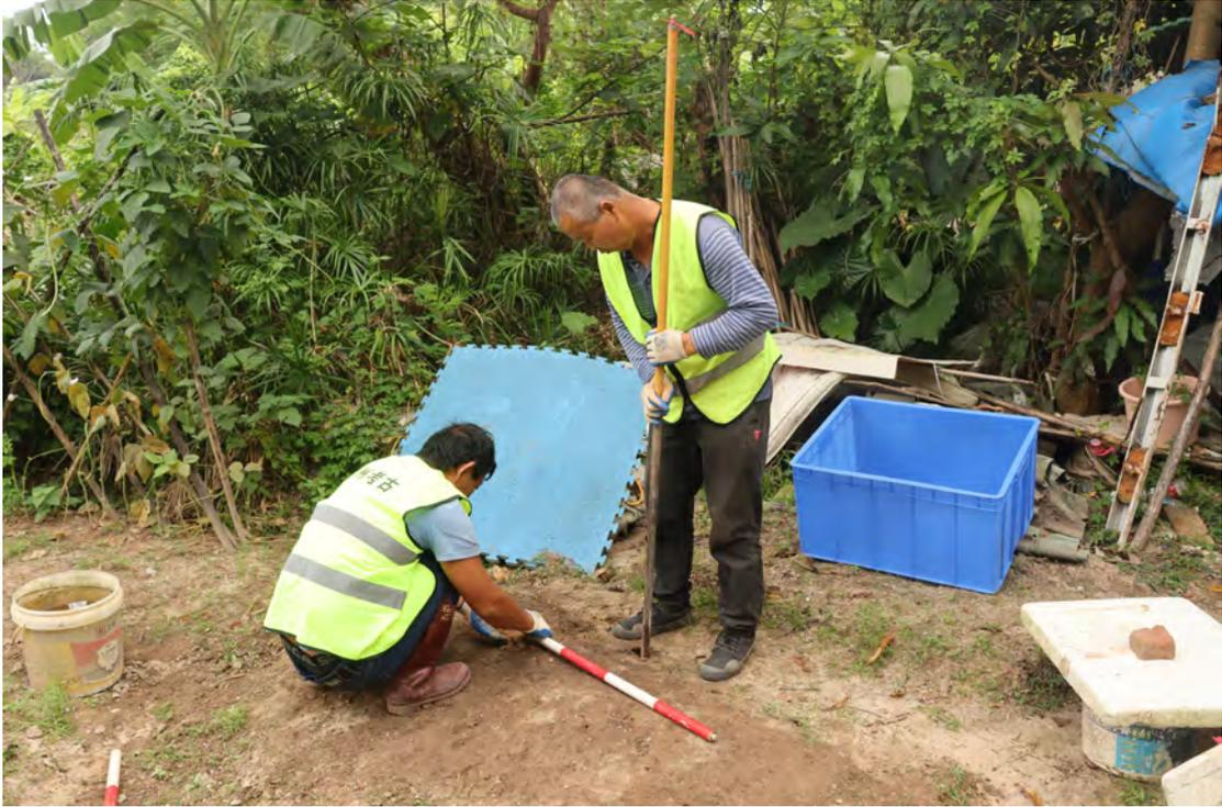
图 31 现场试探土样提取（西-东）
