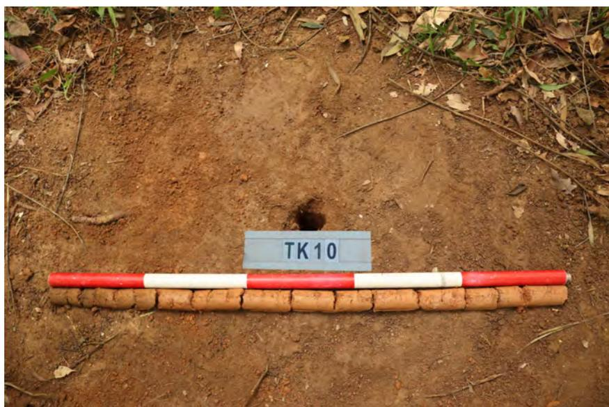
图 42 TK10 土样（标杆长 1 米，土样由左到右）
