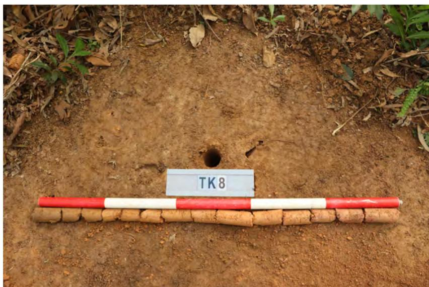
图 40 TK8 土样（标杆长 1 米，土样由左到右）
