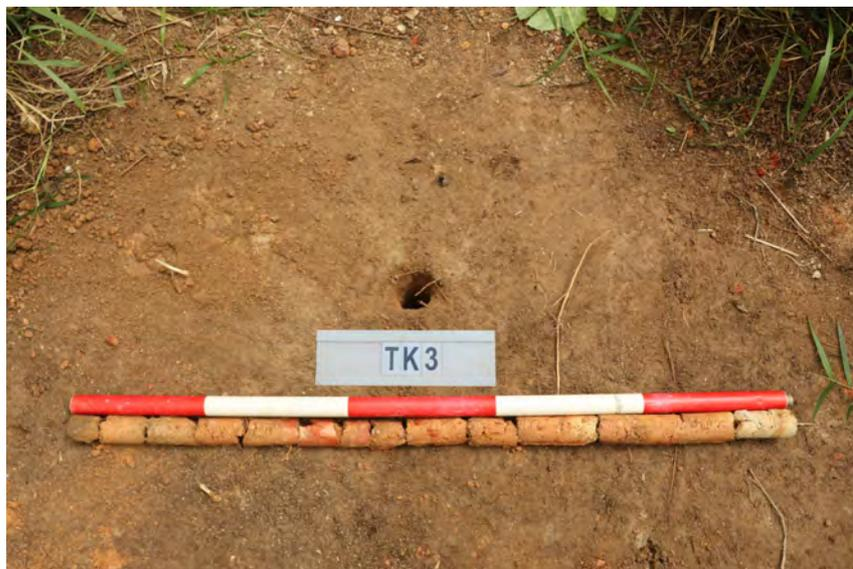
图 35 TK3 土样（标杆长 1 米，土样由左到右）
