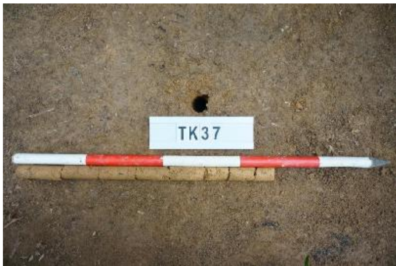
图 90 TK37 土样 (一米标杆, 土样由左往右)
