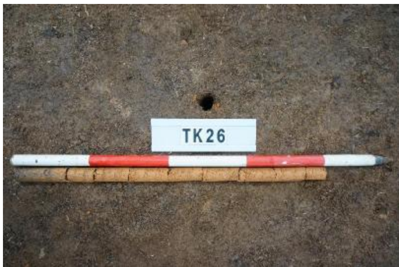
图 79 TK26 土样 (一米标杆, 土样由左往右)
