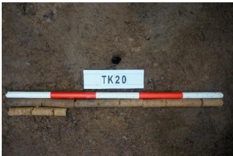
图 73 TK20 土样（一米标杆，土样由左上往右下）
