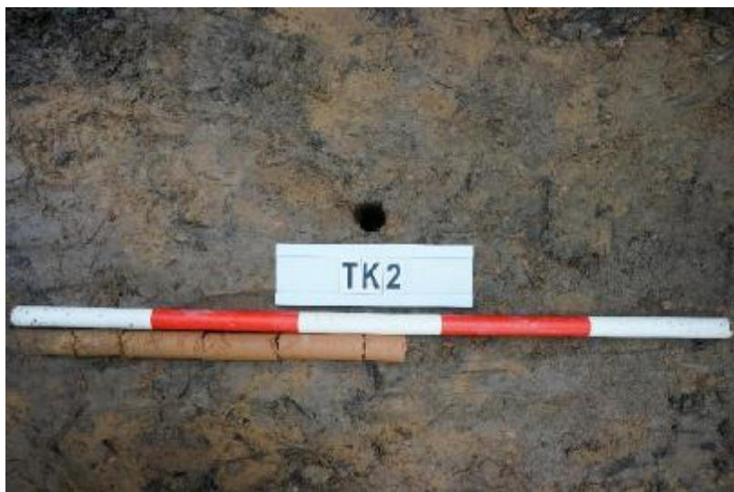
图 55 TK2 土样（一米标杆，土样由左往右）
