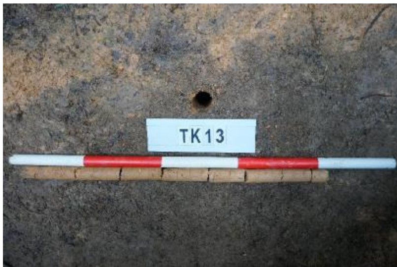
图 66 TK13 土样（一米标杆，土样由左往右）
