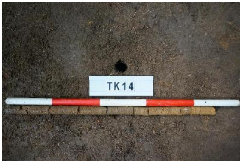
图 67 TK14 土样（一米标杆，土样由左往右）
