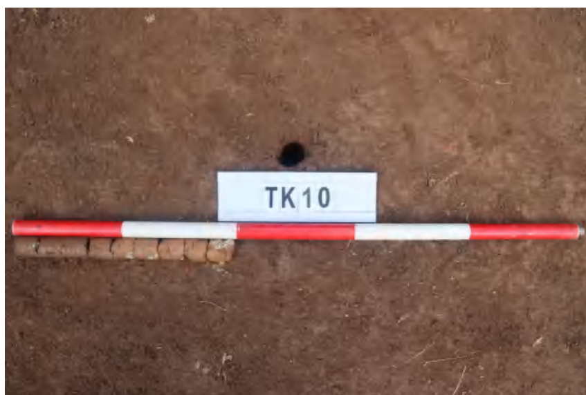
图 40 TK10 土样（一米标杆，土样由左往右）
