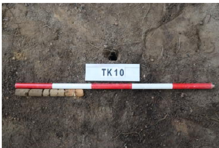
图 47 TK10 土样 (一米标杆, 土样由左往右)
