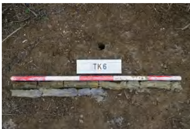
图 39 TK6 土样 (一米标杆,土样由左上往右下)
