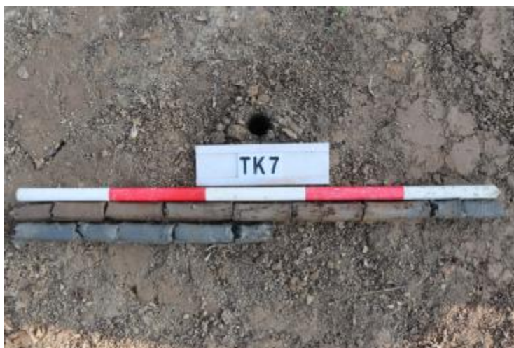
图 53 TK7 土样 (一米标杆, 土样由左上往右下)
