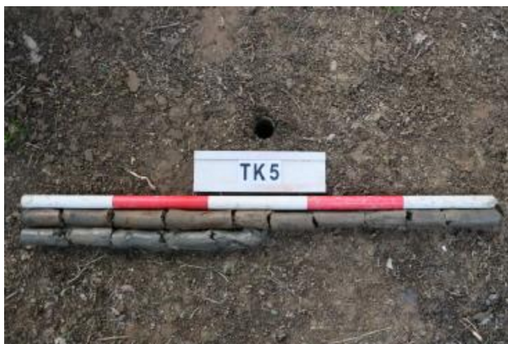
图 51 TK5 土样 (一米标杆, 土样由左上往右下)
