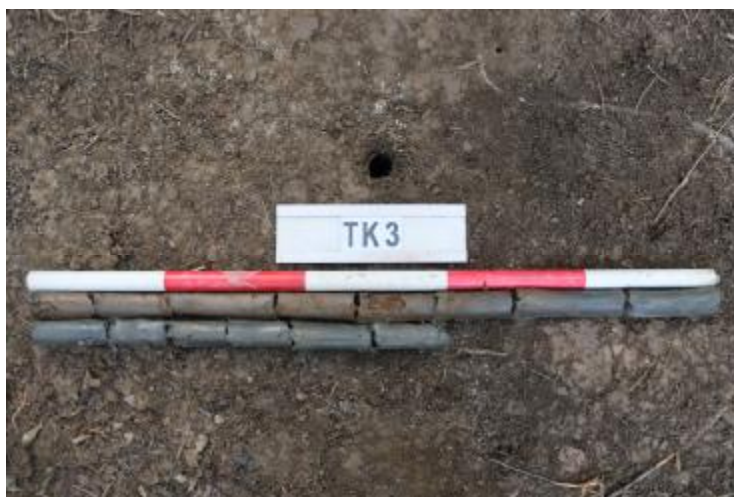
图 49 TK3 土样 (一米标杆, 土样由左上往右下)
