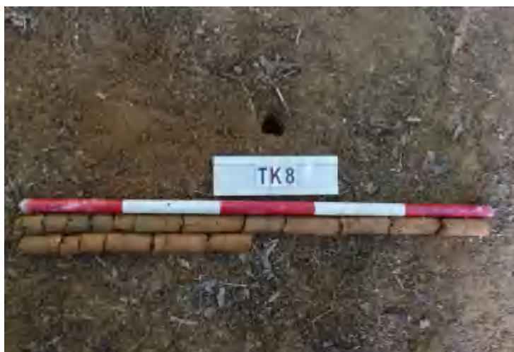
图 39 TK8 土样（一米标杆，土样由左上往右下）
