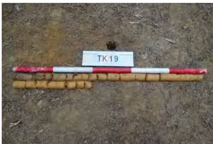
图 47 TK19 土样 (一米标杆, 土样由左上往右下)
