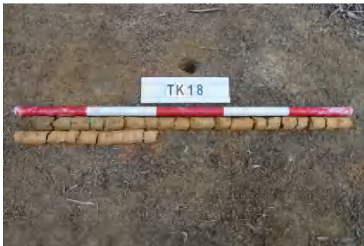
图 46 TK18 土样 (一米标杆, 土样由左上往右下)
