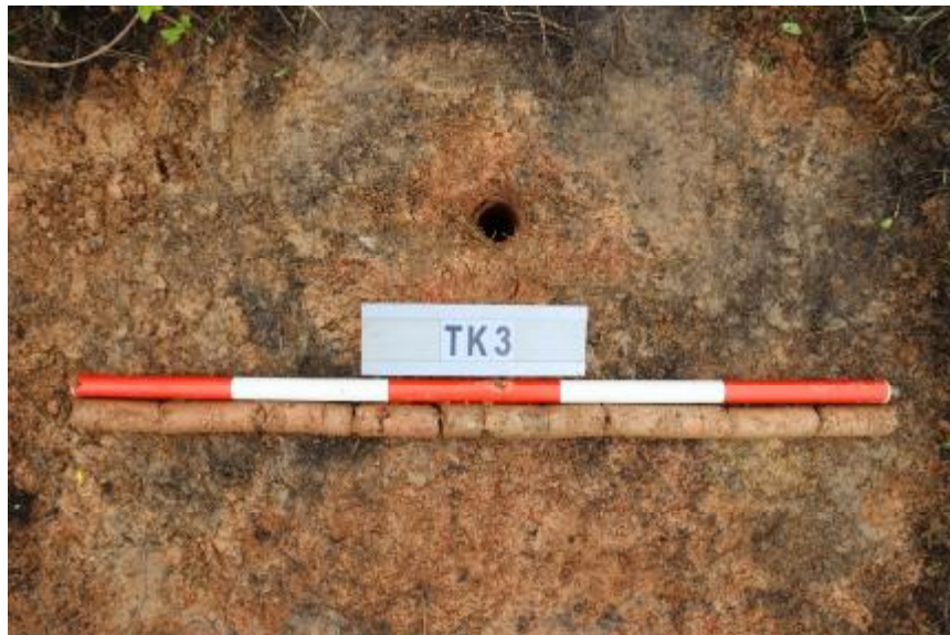
图 36 TK3 土样（一米标杆，土样由左往右）
