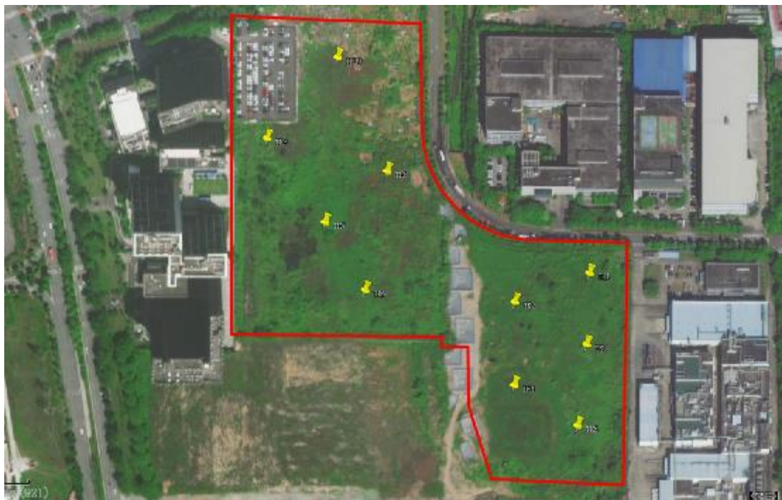
图 30 标准型探孔位置分布图
