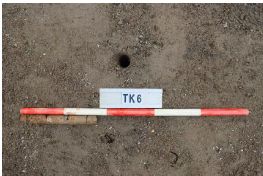
图 39 TK6 土样（一米标杆，土样由左往右）
