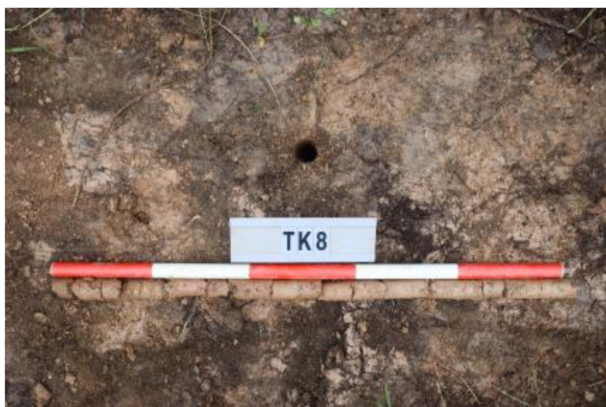
图 41 TK8 土样（一米标杆，土样由左往右）
