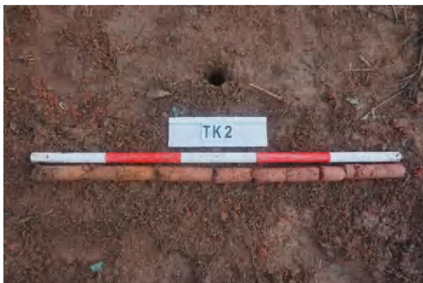
图 38 TK2 土样（标杆长 1 米，土样由左到右）
