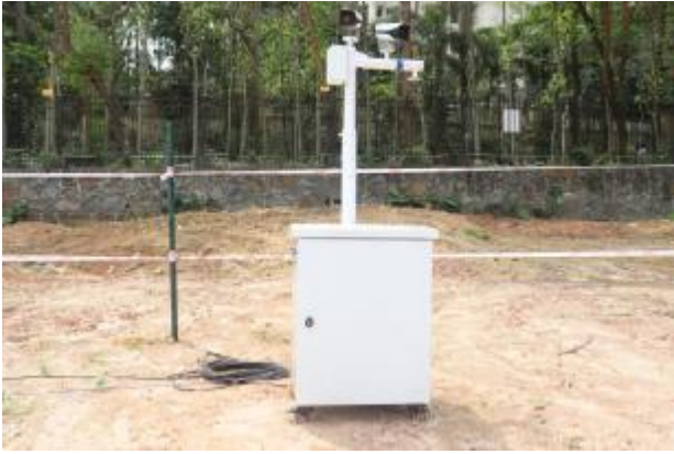
图 22 发掘现场移动监控设备
