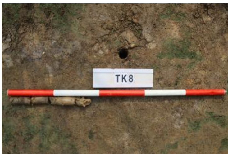
图 41 TK8 土样（一米标杆，土样由左往右）
