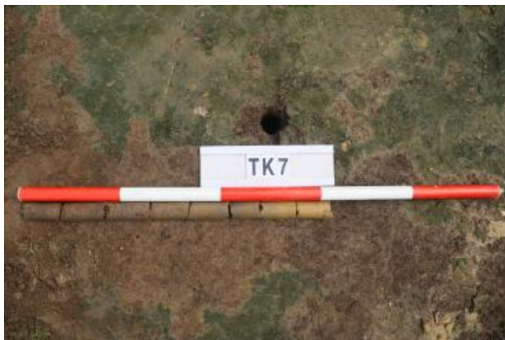
图 40 TK7 土样（一米标杆，土样由左往右）
