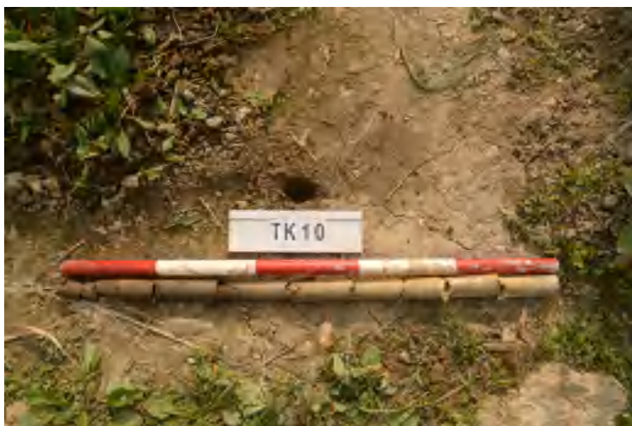
图 29 TK10 土样 (标杆长 1 米, 土样由左到右)
