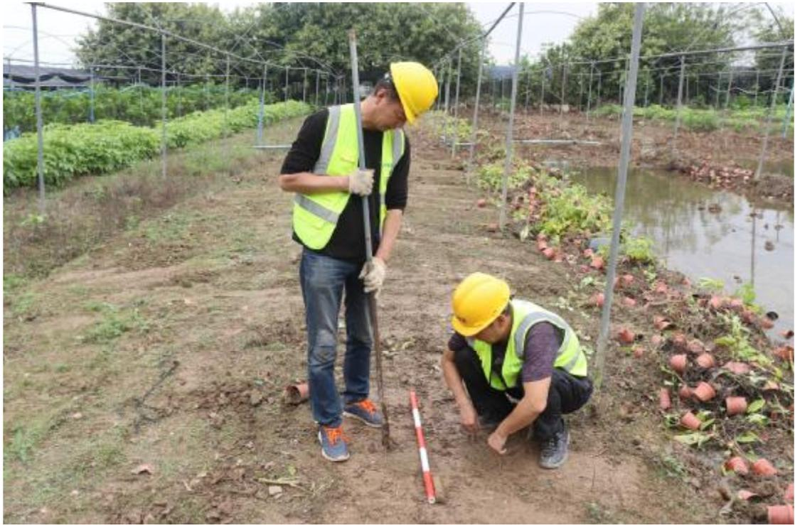
图 21 试探孔提取土样（东南-西北）
