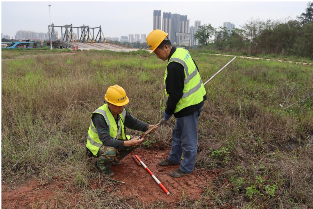
图 27 试探孔土样分析（西-东）
