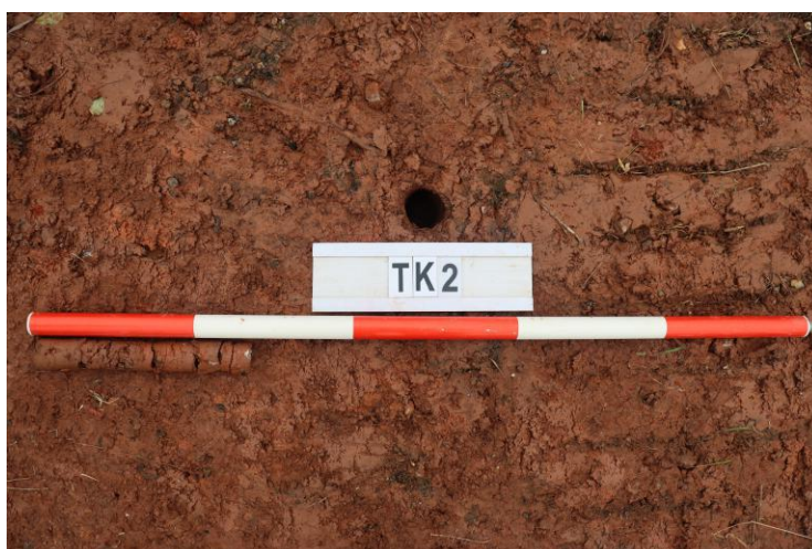
图 29 TK2 土样（一米标杆，土样由左往右）
