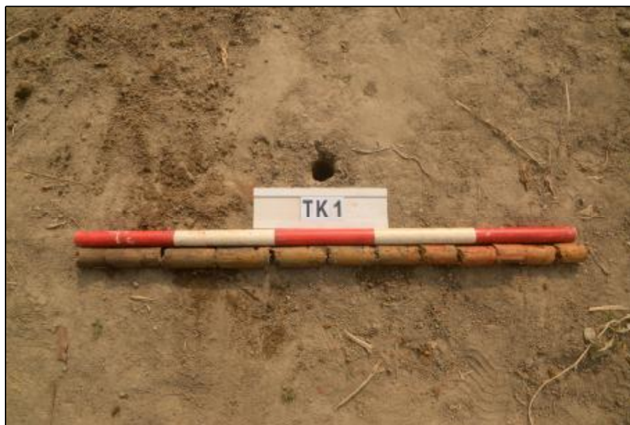
图 104 TK1 土样 (标杆长 1.0 米, 土样从左到右)
