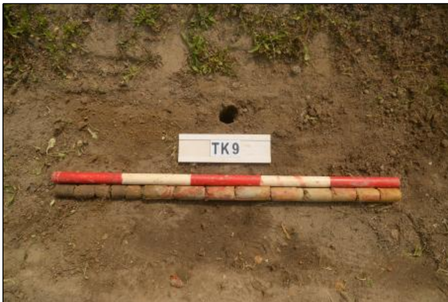
图 112 TK9 土样（标杆长 1.0 米，土样从左到右）
