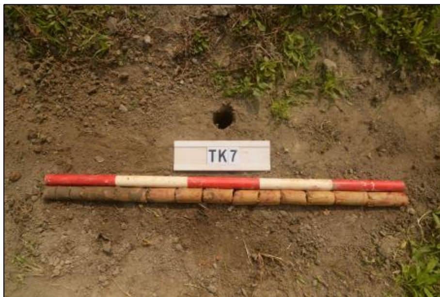
图 110 TK7 土样 (标杆长 1.0 米, 土样从左到右)
