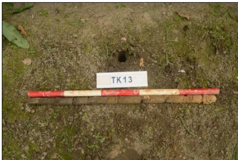
图 116 TK13 土样（标杆长 1.0 米，土样从左到右）
