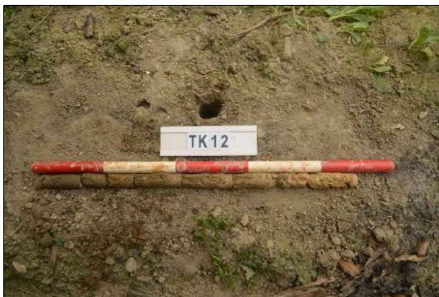
图 115 TK12 土样 (标杆长 1.0 米, 土样从左到右)
