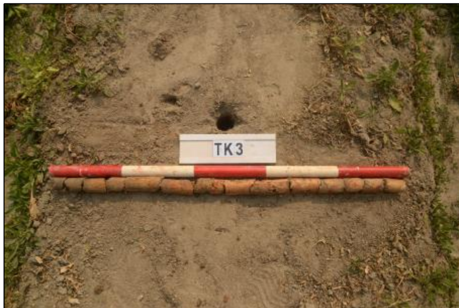
图 106 TK3 土样（标杆长 1.0 米，土样从左到右）
