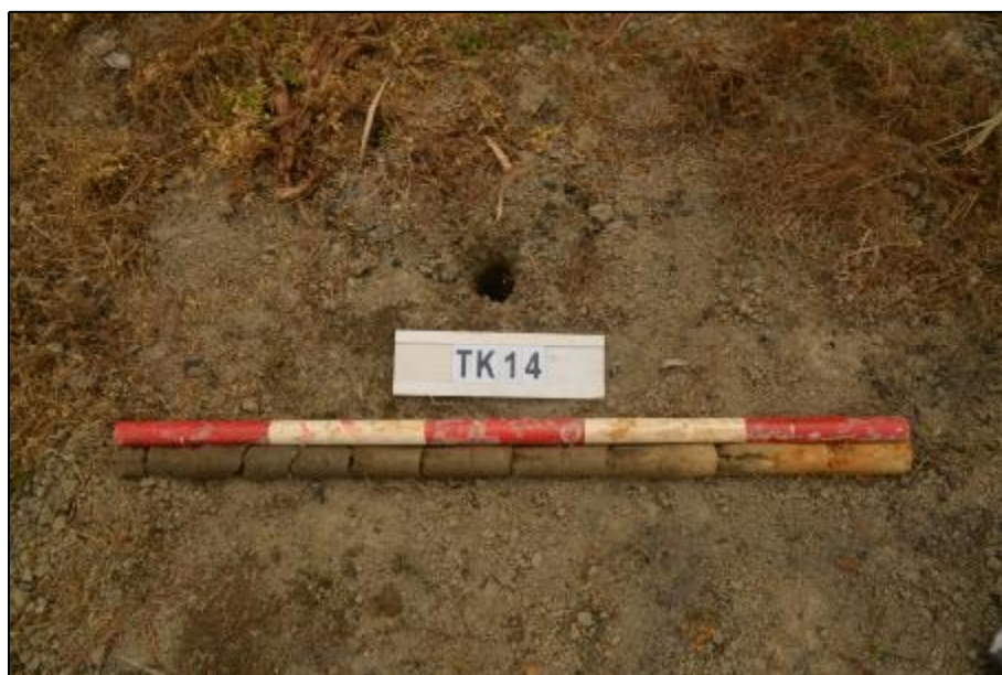
图 117 TK14 土样（标杆长 1.0 米，土样从左到右）
