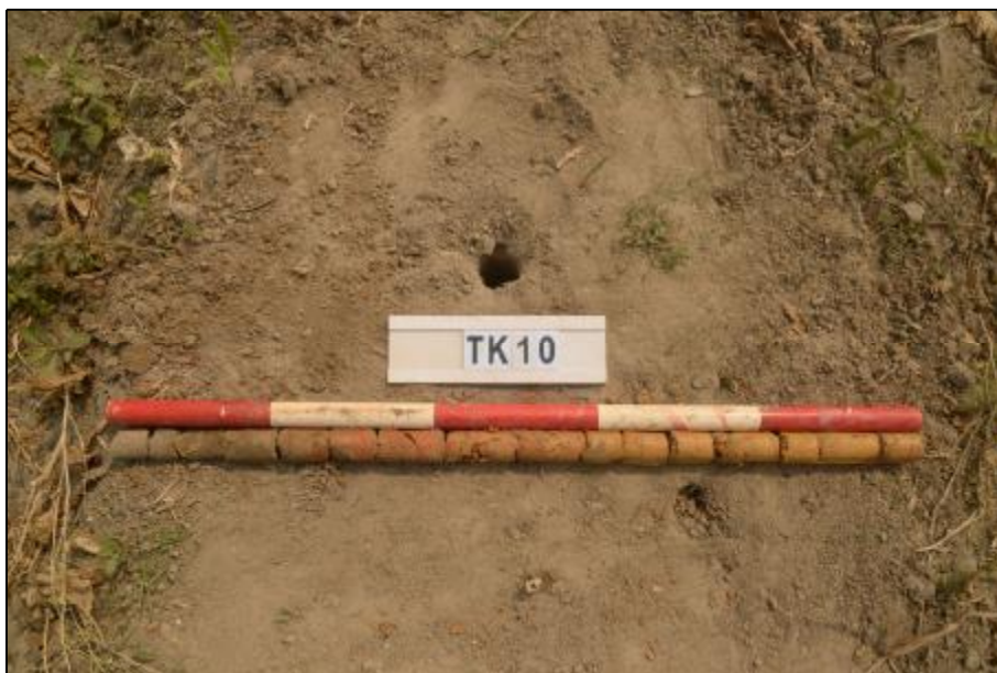
图 113 TK10 土样（标杆长 1.0 米，土样从左到右）
