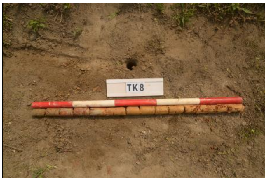
图 111 TK8 土样 (标杆长 1.0 米, 土样从左到右)
