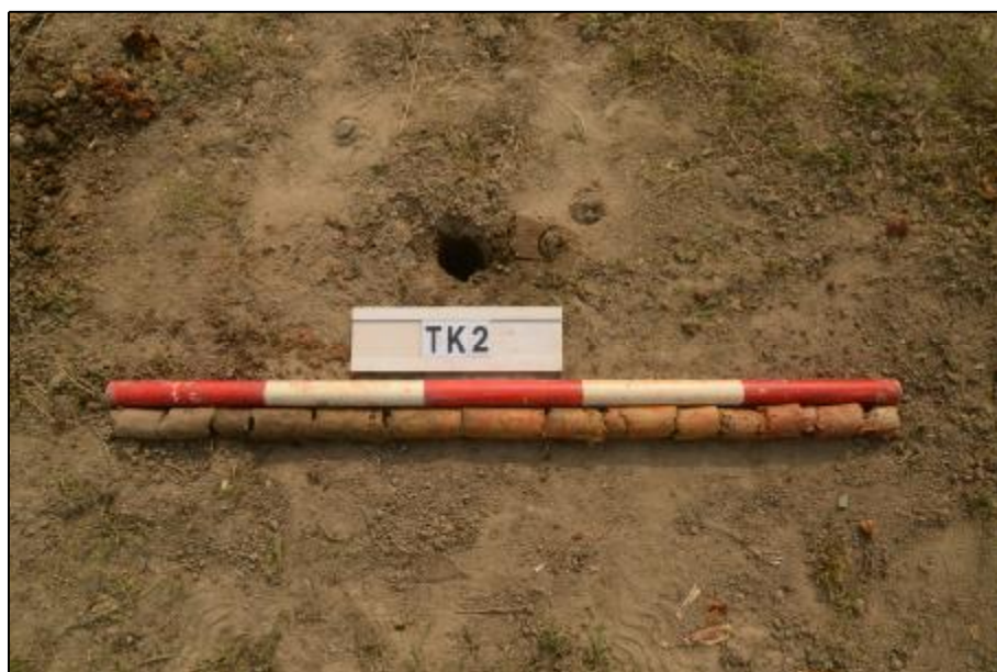
图 105 TK2 土样 (标杆长 1.0 米, 土样从左到右)
