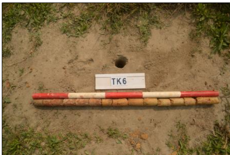
图 109 TK6 土样（标杆长 1.0 米，土样从左到右）
