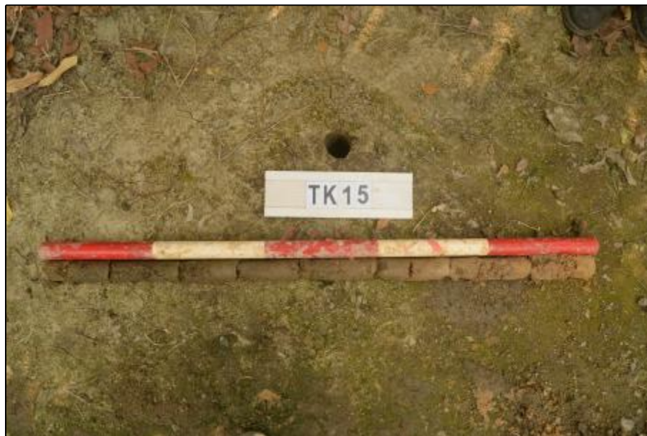
图 118 TK15 土样（标杆长 1.0 米，土样从左到右）
