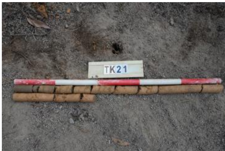
图 73 TK21 土样（一米标杆，土样由左上往右下）
