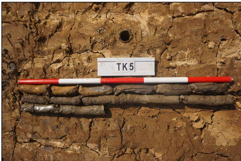
图 45 TK5 土样 (标杆长 1 米, 土样由左到右)
