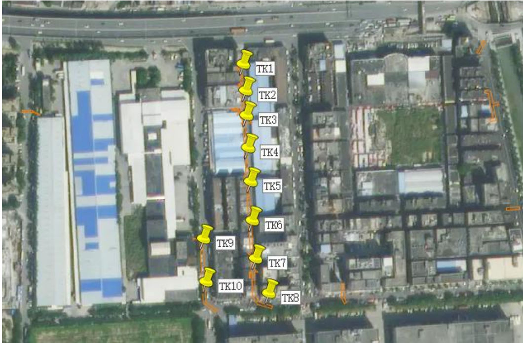
图 22 地块内试探探孔位置示意图（黄色标记点）
