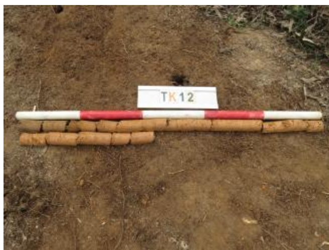
图 48 TK12 土样 (一米标杆, 土样由左上往右下)
