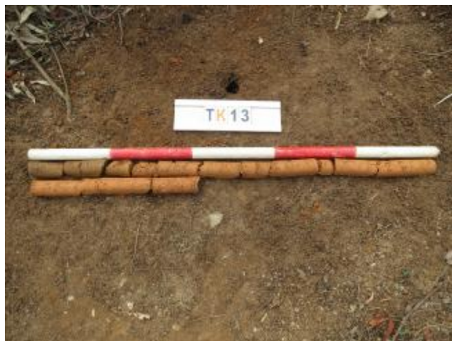
图 49 TK13 土样（一米标杆，土样由左上往右下）
