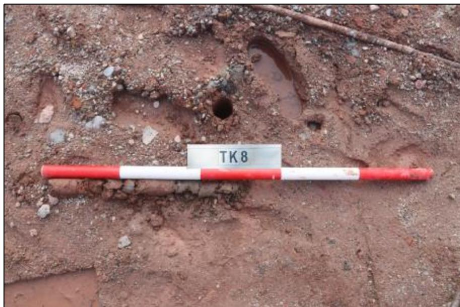
图 27 TK8土样 (标杆长1米, 土样由左上到右下)
