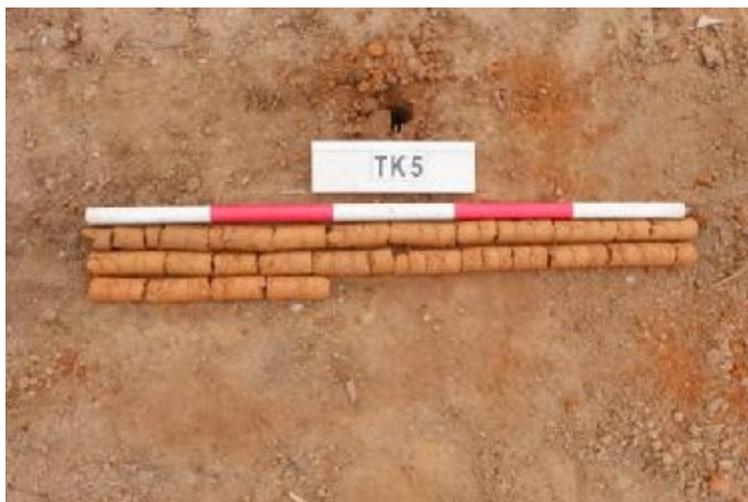
图 35 TK5 土样 (一米标尺, 土样由左上到右下)
