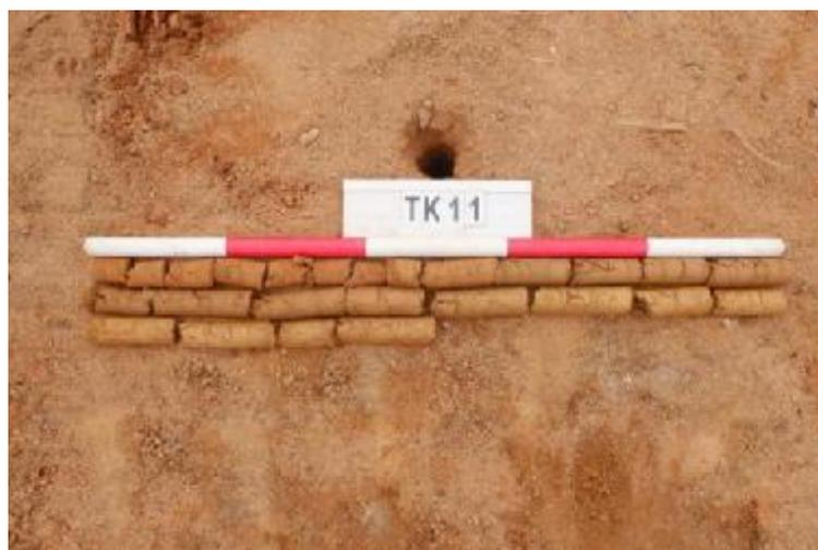
图 41 TK11 土样 (一米标尺, 土样由左到右)
