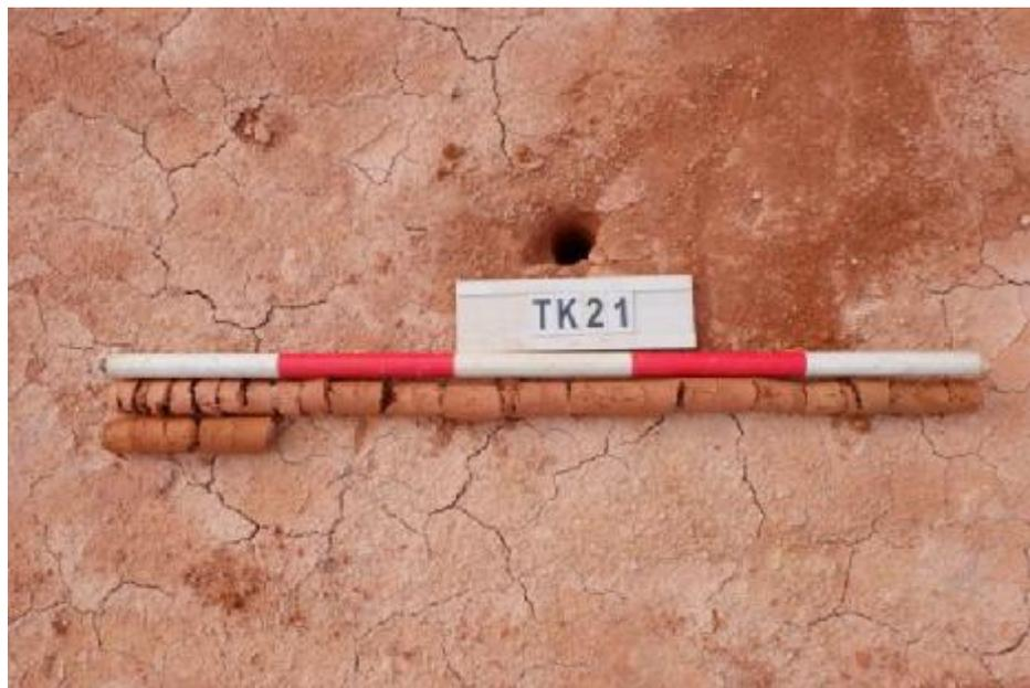
图 51 TK21 土样 (一米标尺, 土样由左上到右下)
