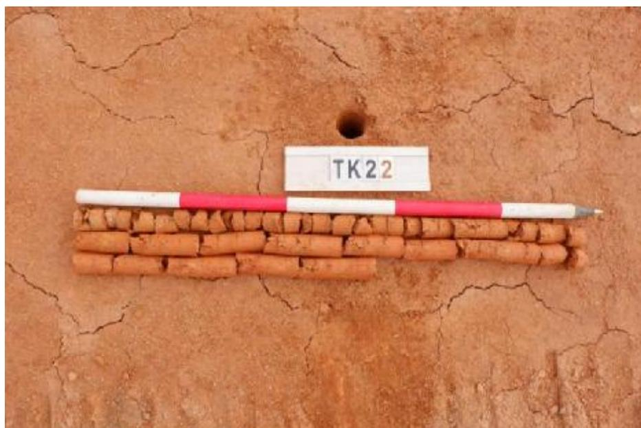
图 52 TK22 土样 (一米标尺, 土样由左上到右下)
