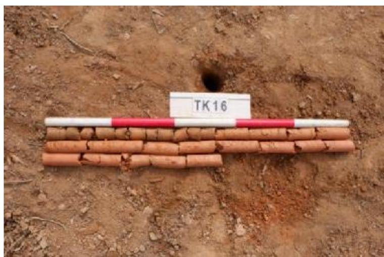
图 46 TK16 土样 (一米标尺, 土样由左上到右下)
