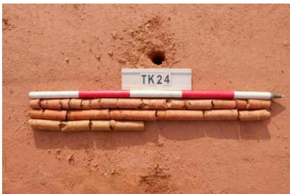
图 54 TK24 土样 (一米标尺, 土样由左上到右下)
