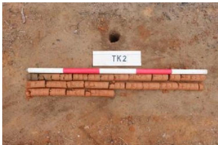
图 32 TK2 土样 (一米标尺, 土样由左上到右下)
