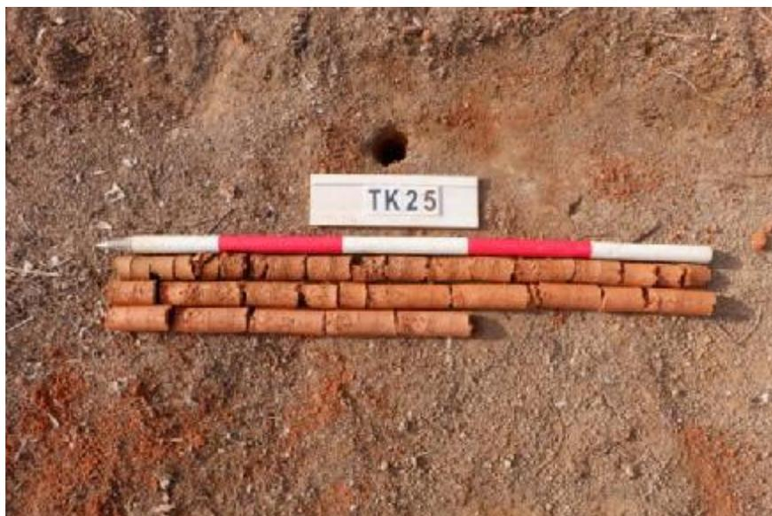
图 55 TK25 土样 (一米标尺, 土样由左上到右下)
