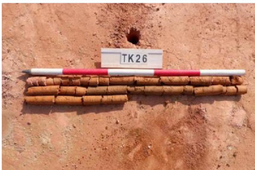
图 56 TK26 土样 (一米标尺, 土样由左上到右下)
