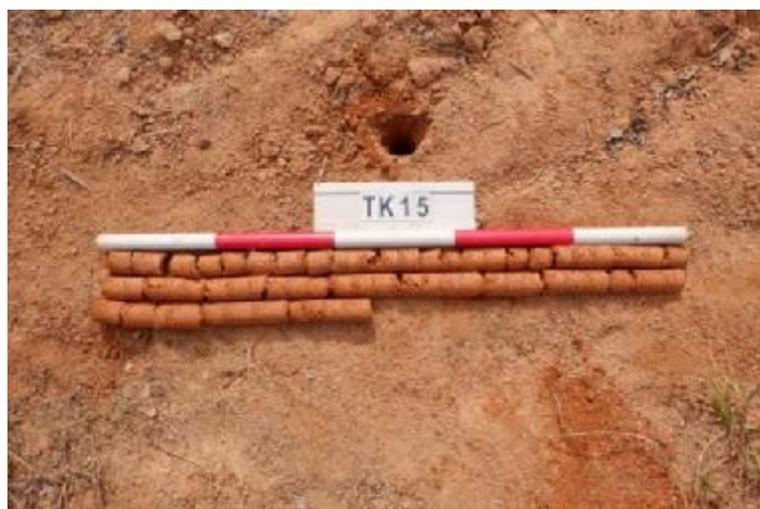
图 45 TK15 土样 (一米标尺, 土样由左上到右下)
