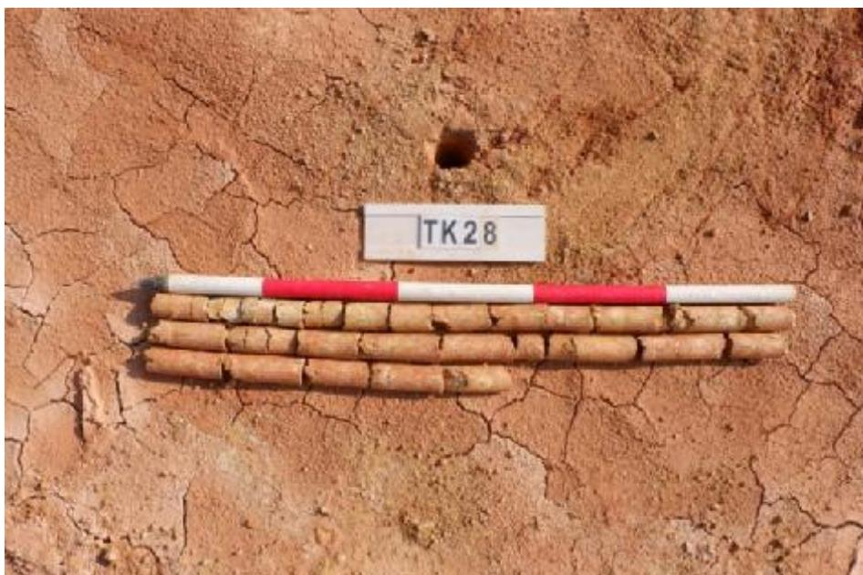
图 58 TK28 土样 (一米标尺, 土样由左上到右下)
