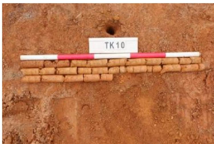
图 40 TK10 土样 (一米标尺, 土样由左上到右下)
