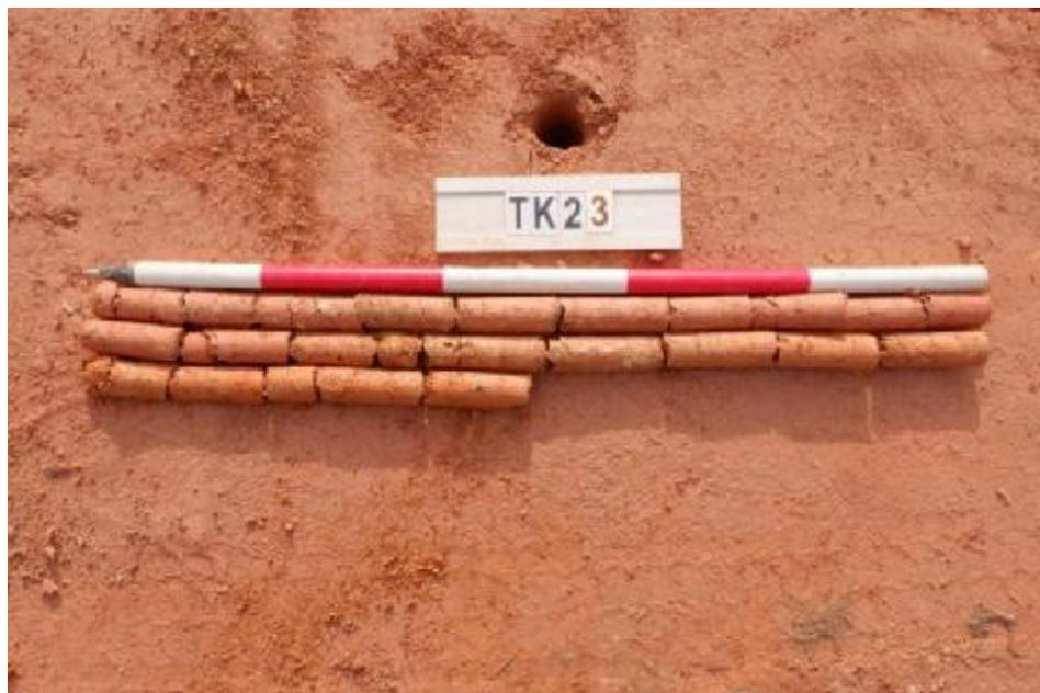
图 53 TK23 土样 (一米标尺, 土样由左上到右下)
