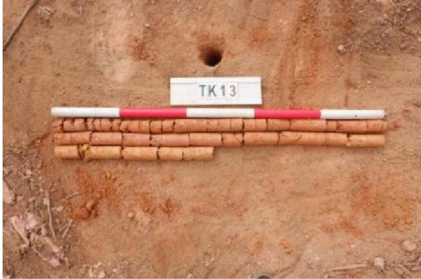
图 43 TK13 土样 (一米标尺, 土样由左到右)
