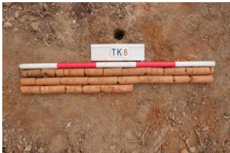
图 38 TK8 土样 (一米标尺, 土样由左上到右下)
