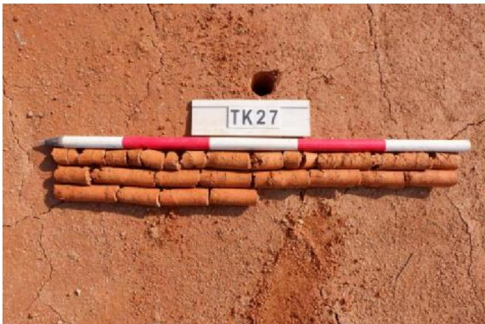
图 57 TK27 土样 (一米标尺, 土样由左上到右下)
