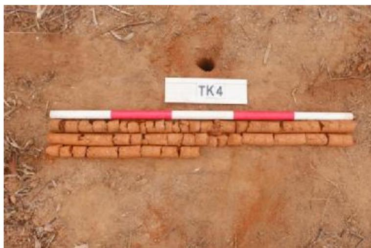
图 34 TK4 土样 (一米标尺, 土样由左上到右下)
