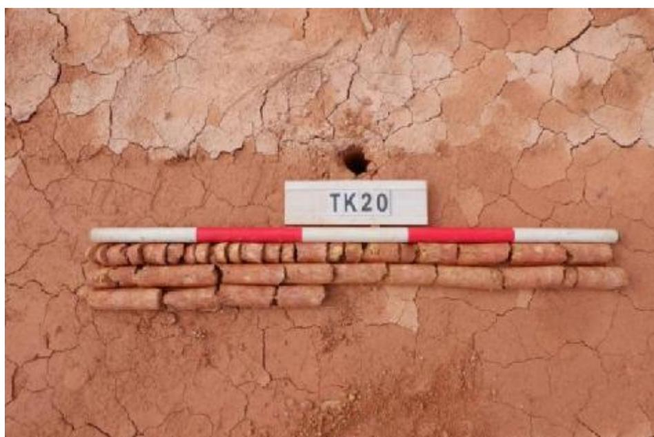
图 50 TK20 土样 (一米标尺, 土样由左上到右下)
