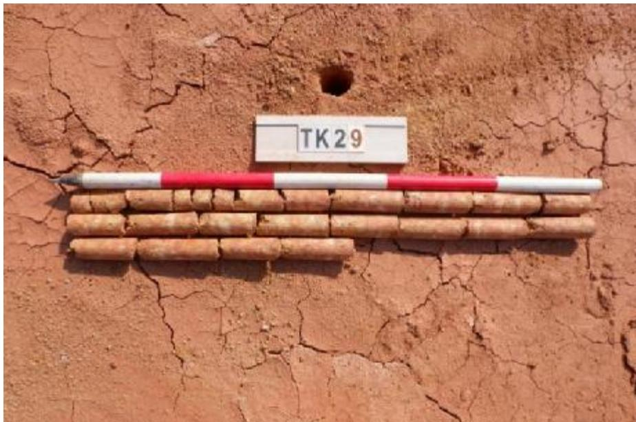
图 59 TK29 土样 (一米标尺, 土样由左上到右下)
