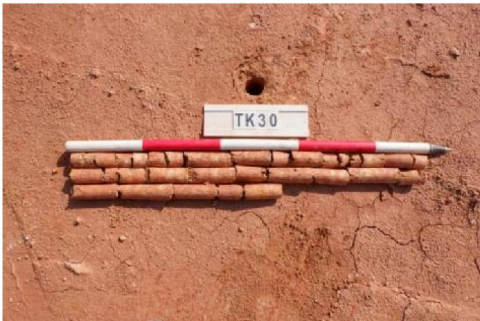
图 60 TK30 土样 (一米标尺, 土样由左上到右下)
