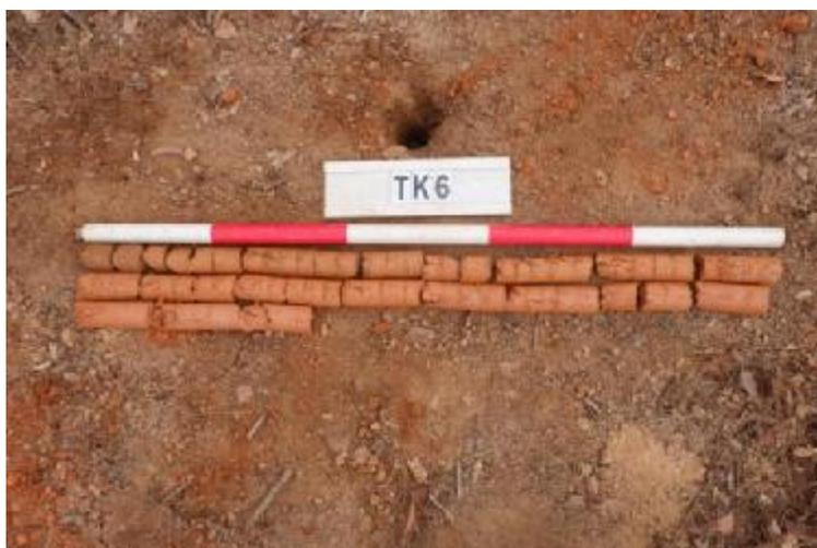
图 36 TK6 土样 (一米标尺, 土样由左上到右下)
