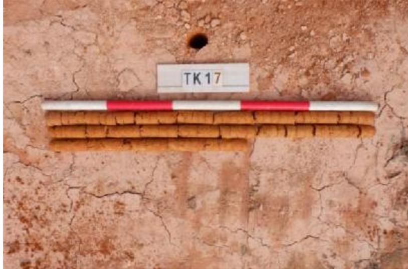
图 47 TK17 土样 (一米标尺, 土样由左上到右下)
