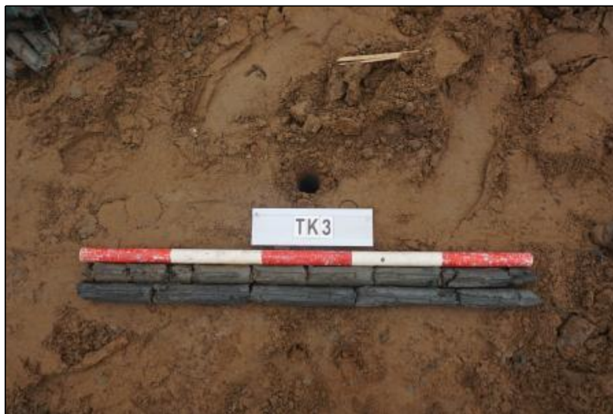
图 44 TK3 土样（标杆长 1.0 米，土样由左上到右下）
