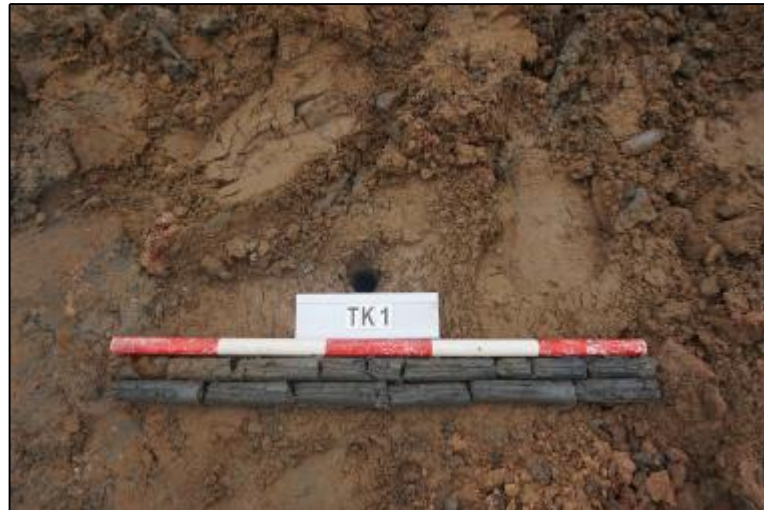
图 42 TK1 土样（标杆长 1.0 米，土样由左上到右下）
