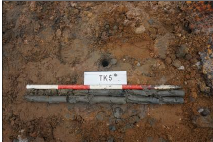
图 46 TK5 土样（标杆长 1.0 米，土样由左上到右下）
