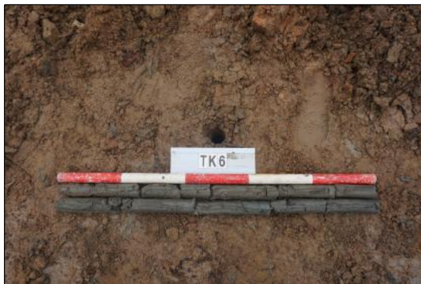
图 47 TK6 土样（标杆长 1.0 米，土样由左上到右下）
