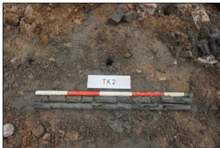
图 43 TK2 土样（标杆长 1.0 米，土样由左上到右下）
