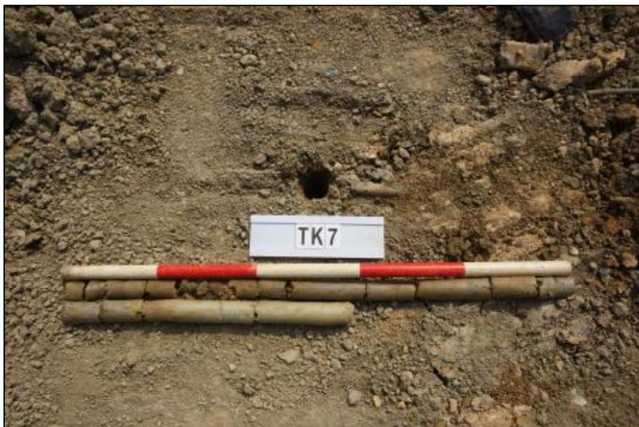
图 40 TK7 土样 (标杆长 1.0 米, 土样由左上到右下)
