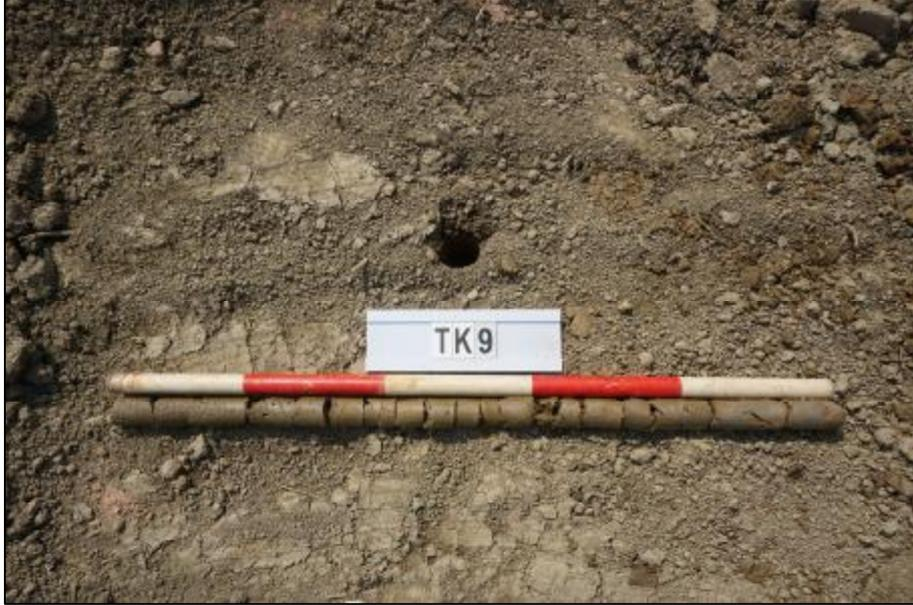
图 42 TK9 土样 (标杆长 1.0 米, 土样由左上到右下)
