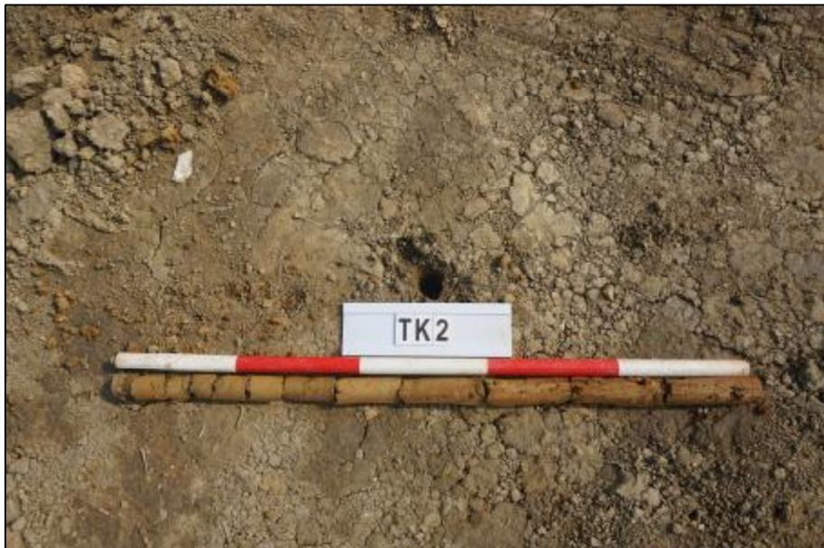
图 35 TK2 土样 (标杆长 1.0 米, 土样由左上到右下)
