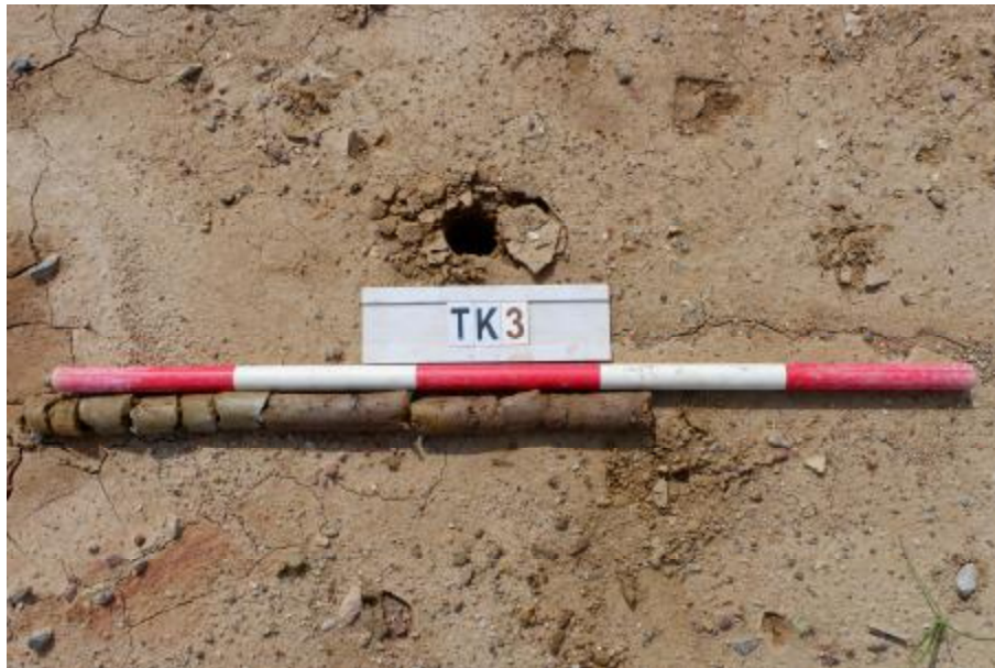
图 37 TK3土样（一米标杆，土样由左上到右下）
