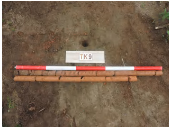
图 35 TK9 土样（一米标杆，土样由左上往右下）
