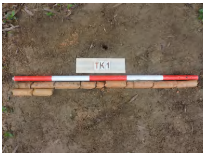
图 27 TK1 土样 (一米标杆, 土样由左上往右下)
