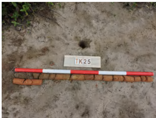
图 51 TK25 土样（一米标杆，土样由左上往右下）
