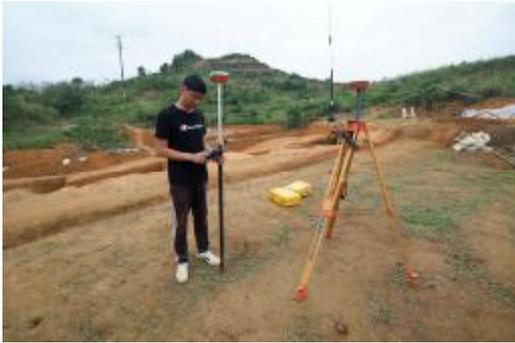
图 26 使用rtk测量
