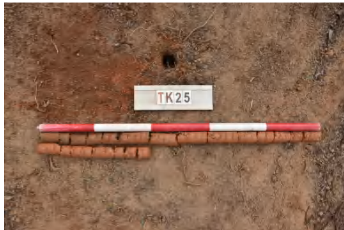
图 59 TK25 土样 (一米标杆,土样由左上往右下)
