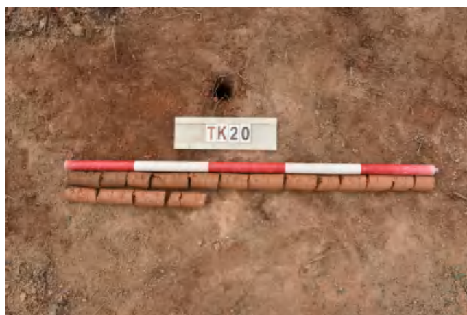
图 54 TK20 土样（一米标杆，土样由左上往右下）
