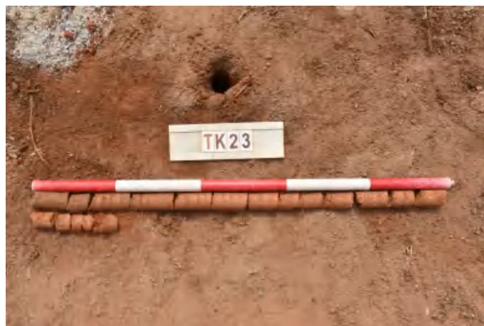
图 57 TK23 土样 (一米标杆, 土样由左上往右下)
