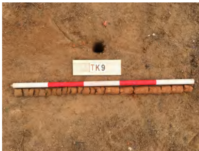
图 43 TK9 土样 (一米标杆,土样由左往右)
