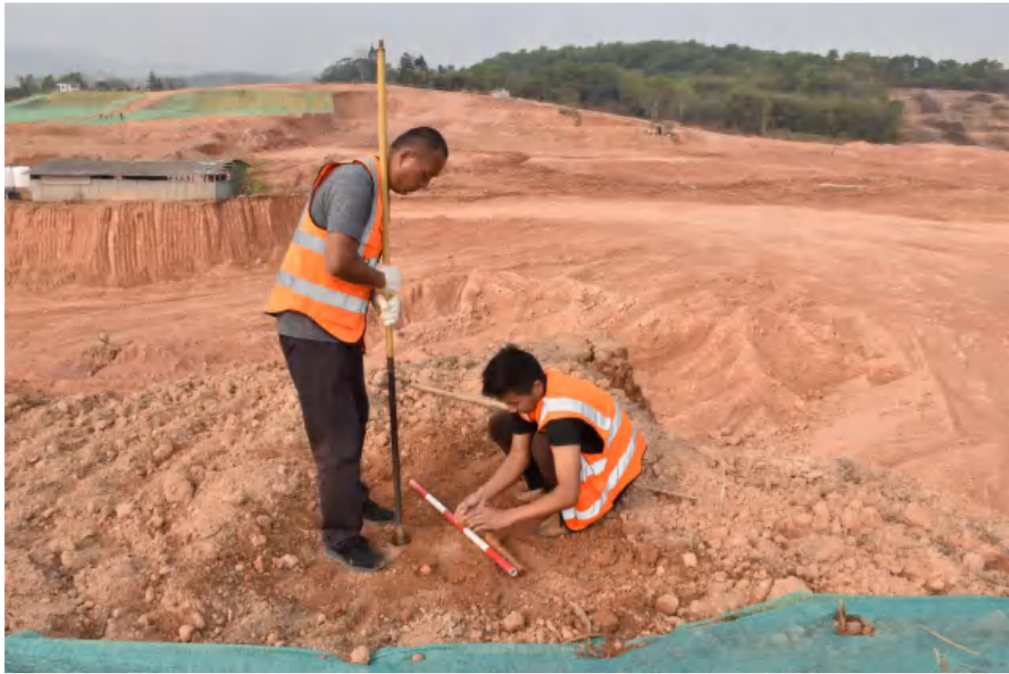
图 33 标准孔土样提取（东—西）
