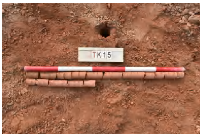
图 49 TK15 土样 (一米标杆, 土样由左上往右下)
