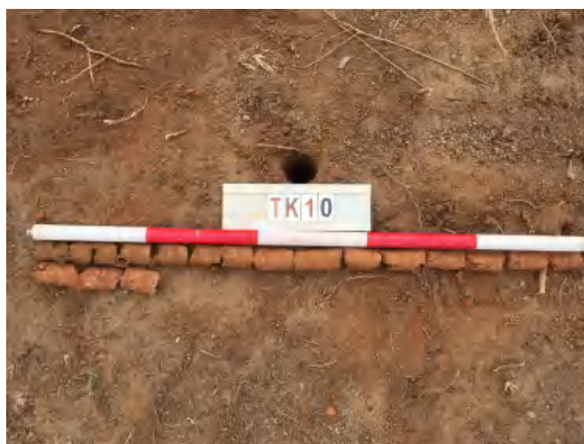
图 44 TK10 土样 (一米标杆,土样由左上往右下)
