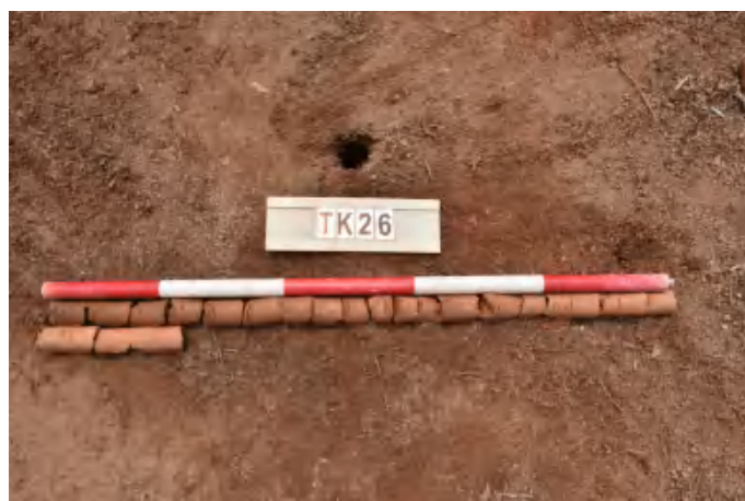
图 60 TK26 土样 (一米标杆,土样由左上往右下)
